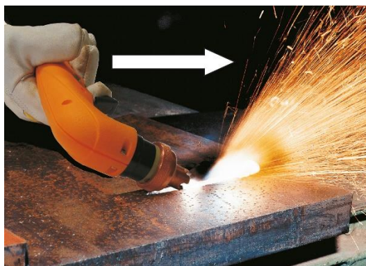
Slika 2.14. Plazma dubljenje (žlijebljenje) [12]
