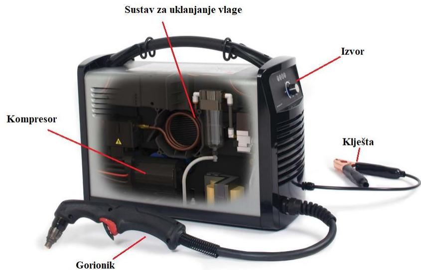
Slika 5.3. Dijelovi Hypertherm® Powermax 30 AIR [30]
