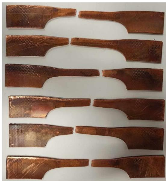
Slika 5.26. Uzorci nakon ispitivanja vlačne čvrstoće [36]
