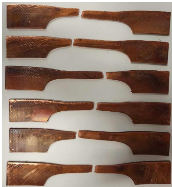
Slika 5.26. Uzorci nakon ispitivanja vlačne čvrstoće [36]
