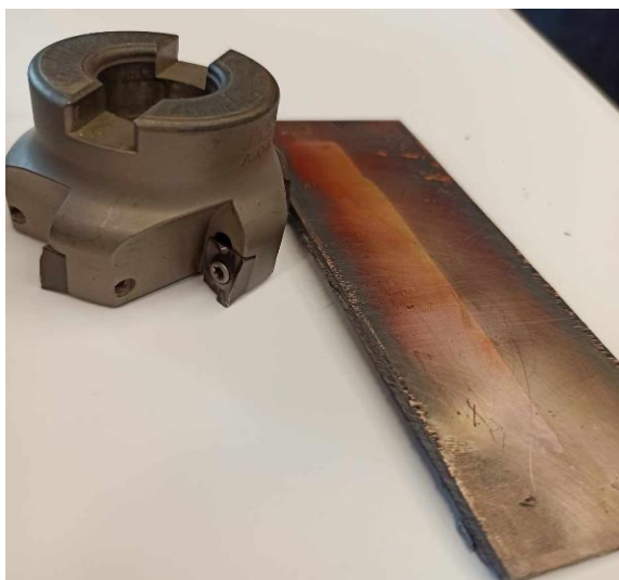
Slika 5.20. Uzorak spreman za strojnu obradu glodanjem [36]
