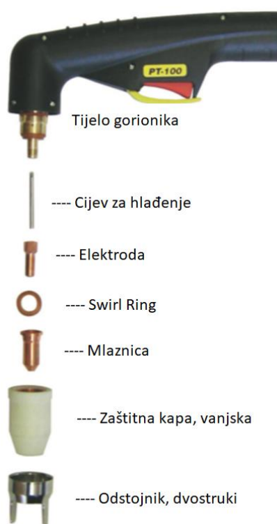
Slika 2.17. Dijelovi gorionika ručnog plazma rezača koji radi pomoću komprimiranog zraka [15]
