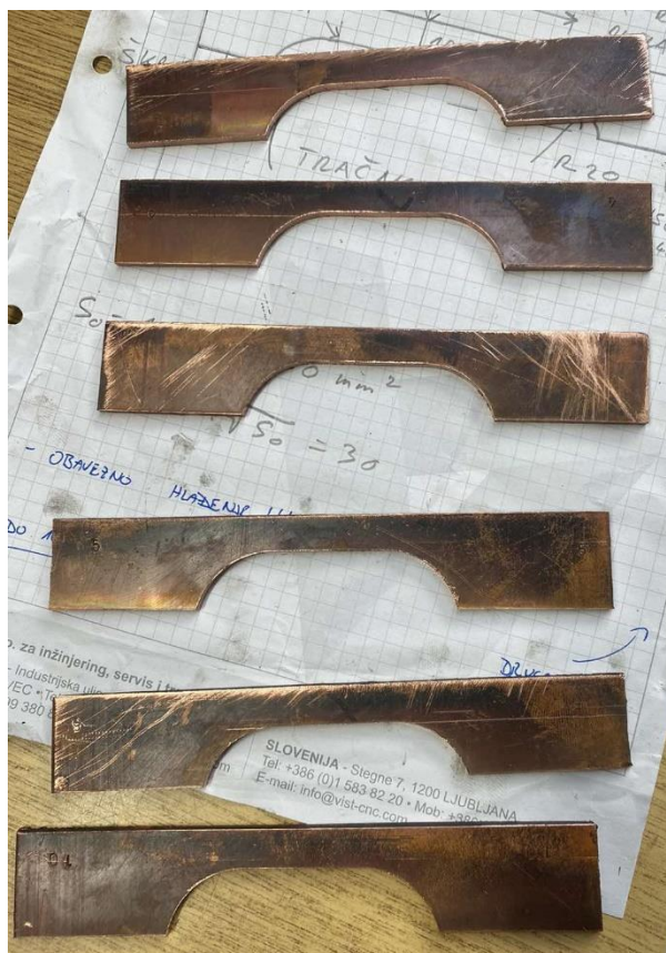
Slika 5.21. Novi uzorci izrađeni strojnom obradom glodanja [36]
