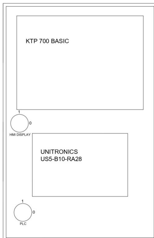
Slika 4.10 Panel 2 nacrt za montažu
