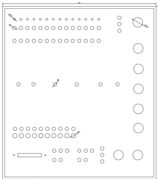
Slika 4.11 Panel 1 nacrt za bušenje
