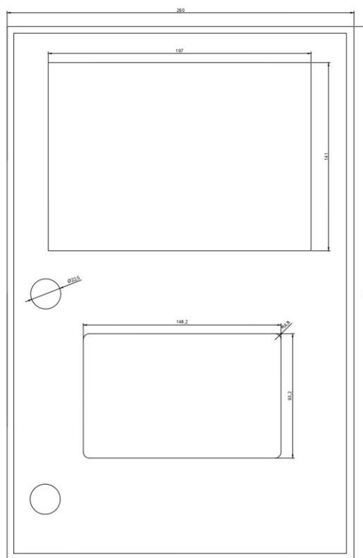
Slika 4.12 Panel 2 nacrt za bušenje
