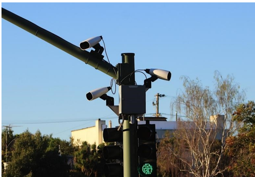
Slika 4.4. Stacionarne ANPR kamere, izvor:
