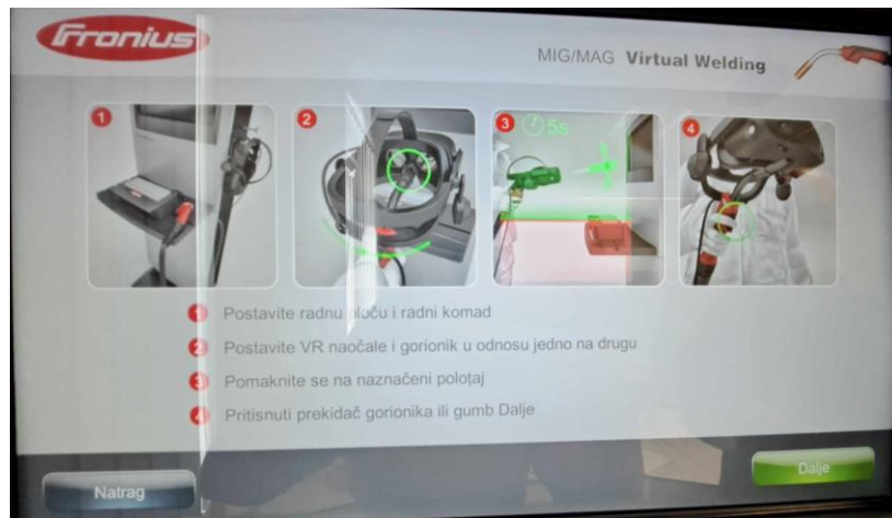
Slika 7.3. Kalibracija prije početka rada
