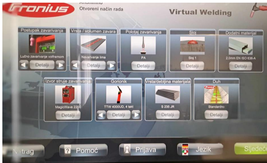
Slika 5.12. Parametri za TIG zavarivanje
