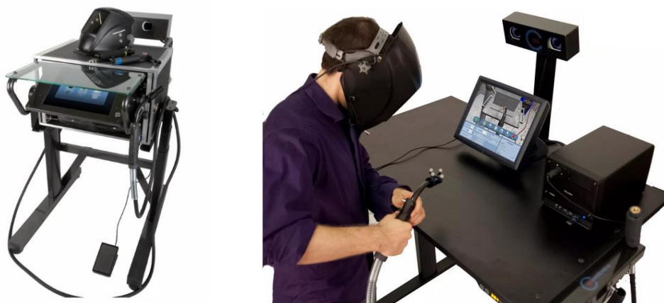
Slika 5.1. Mobilna (lijevo) i stolna (desno) izvedba Arc+ simulatora za zavarivanje [17]
