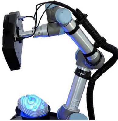
Slika 9 Robot s senzorom za 3D skeniranje [17]
