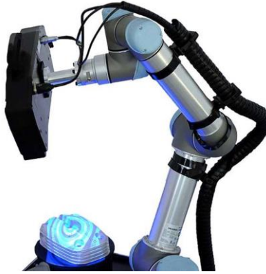
Slika 9 Robot s senzorom za 3D skeniranje [17]
