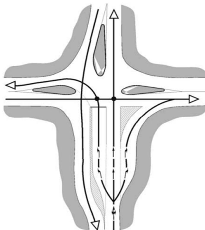
Slika 6. Kontrolirano vođenje lijevog skretanja na kanaliziranom četverokrakom raskrižju
