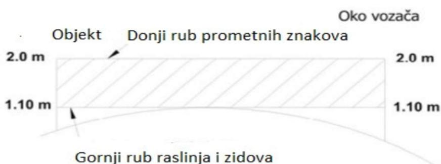
Slika 68. Pregledna udaljenost na ulazu s lijeve strane [3]
