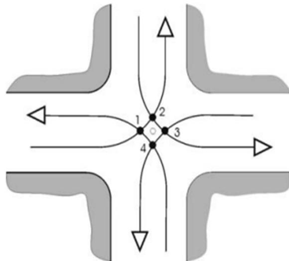
Slika 3. Nekanalizirano vođenje lijevog skretanja na četverokrakom raskrižju [17]
