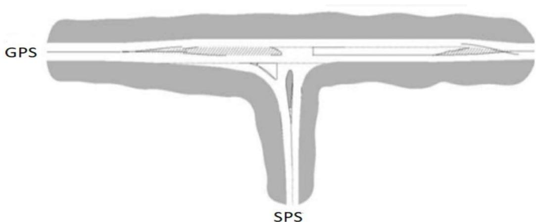
Slika 17. Priključna točka tip II (bez trake za skretanje desno) [17]
