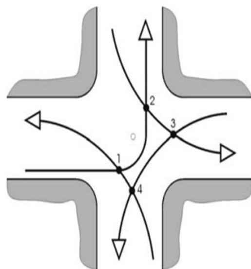
Slika 4. Nekanalizirano vođenje lijevog skretanja na četvorokrakom raskrižju [17]
