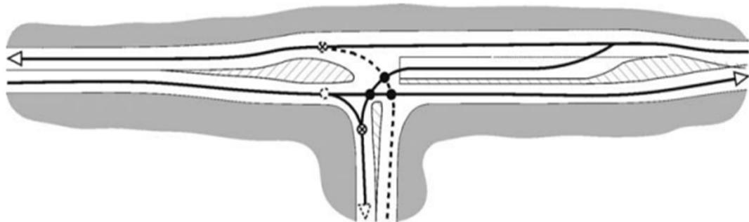
Slika 7. Usmjeravanje vozila mjerama usmjerena - otoka [17]
