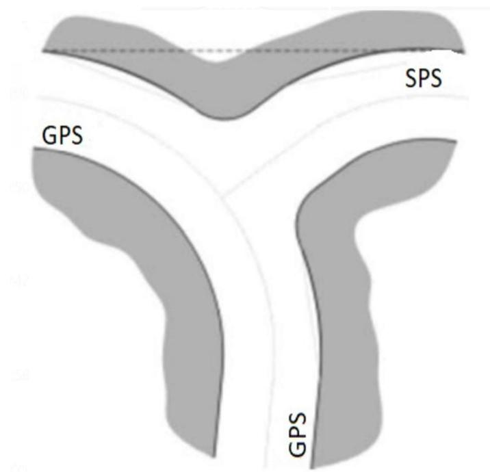
Slika 12. Pravilno vođenje GPS na trokrakom raskrižju [17]
