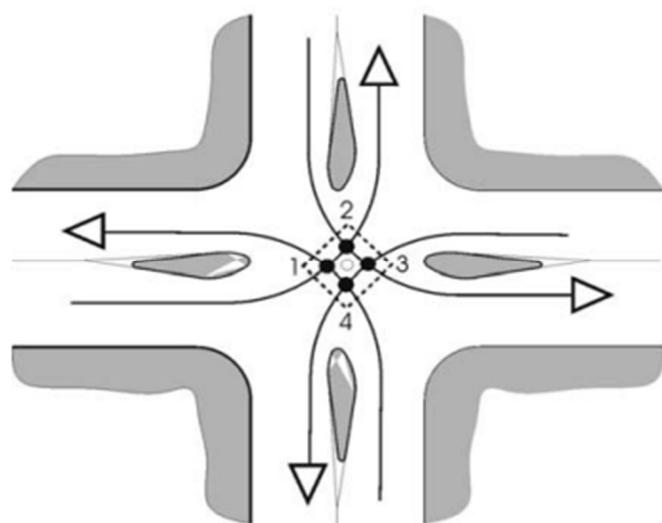
Slika 5. Kontrolirano vođenje lijevog skretanja na kanaliziranom četvorokrakom raskrižju
