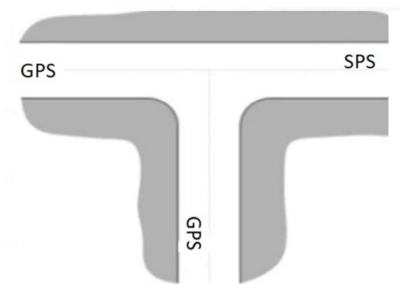
Slika 13. Nepravilno vođenje GPS na trokrakom raskrižju [17]
