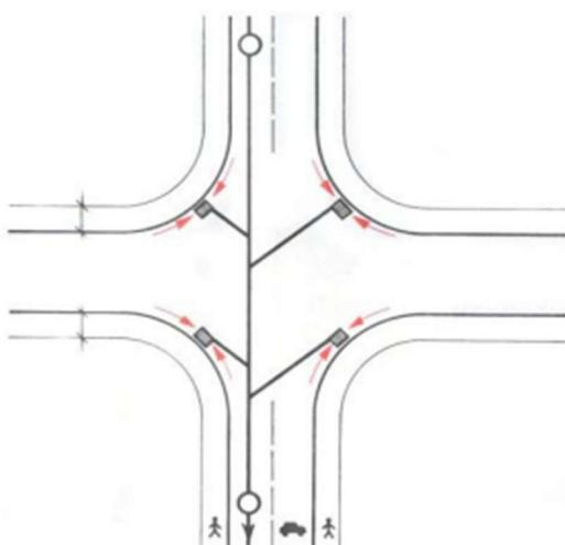
Slika 40. Odvodnja raskrižja s minimalnim uzdužnim nagibom [17]
