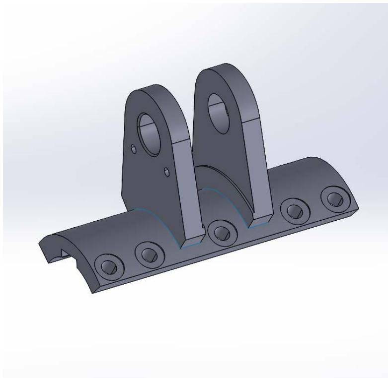
*Slika 39. Model poluge napravljen u programu SolidWorks [28]*
