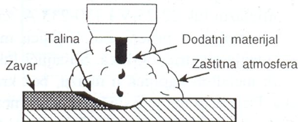
Slika 11. Prikaz zaštitne atmosfere plina prilikom zavarivanja [17]
