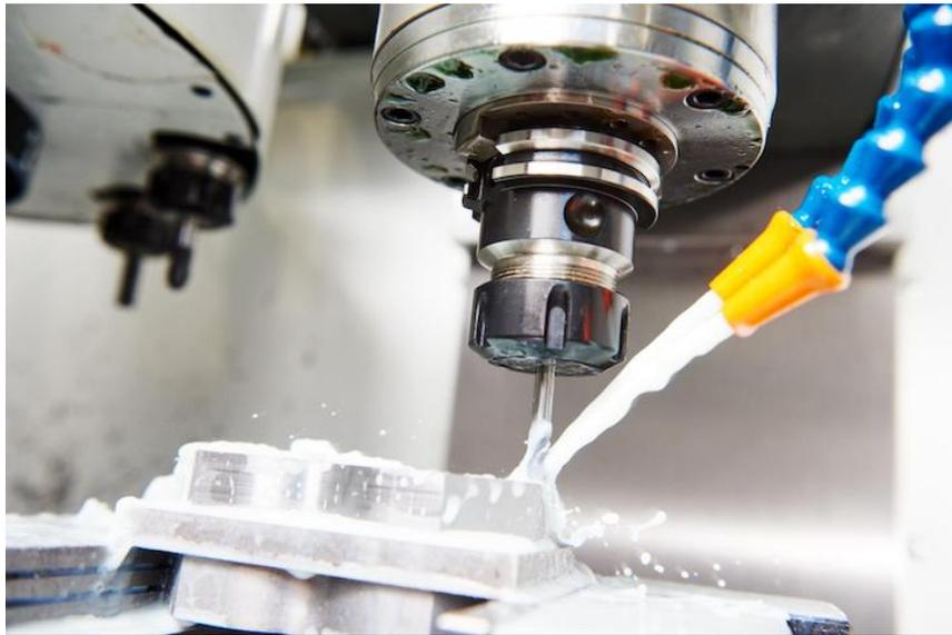
*Slika 19. Dovođenje sredstva za hlađenje kroz vanjsku dovodnu cijev [22]*
