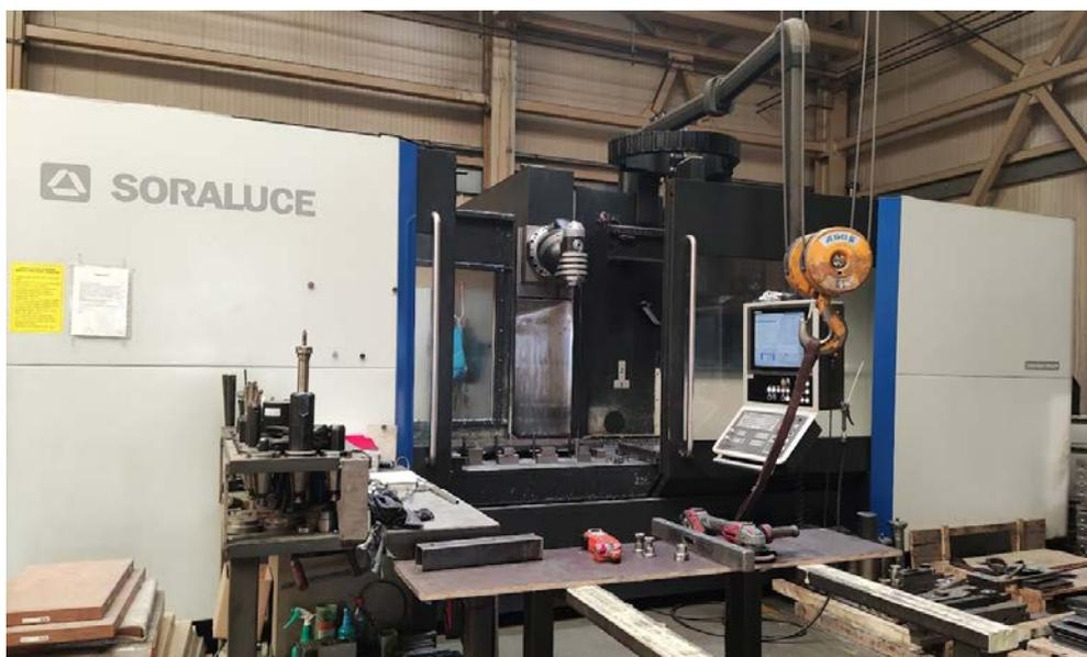
*Slika 40. CNC glodači obradni centar Soraluce TA-A 25 [28]*
