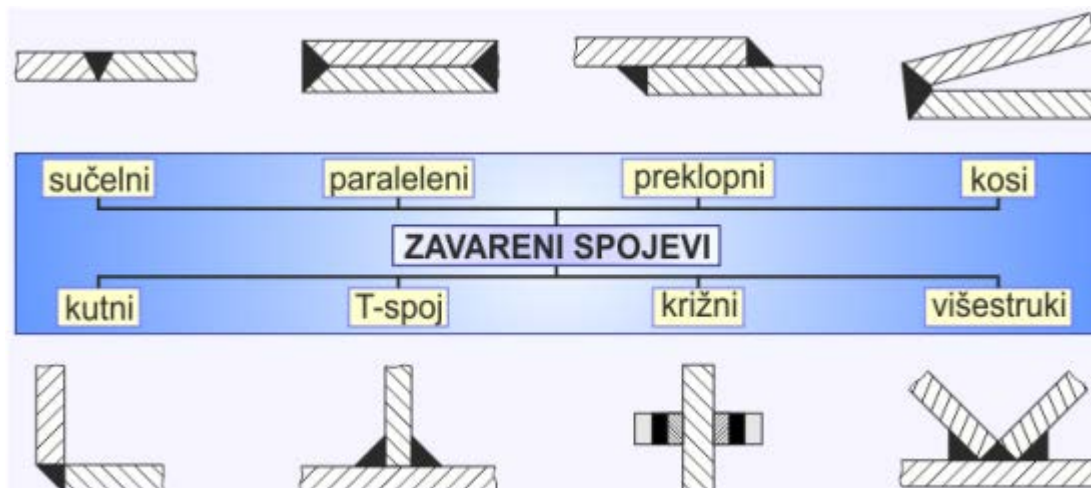
Slika 10. Vrste zavarenih spojeva [13]
