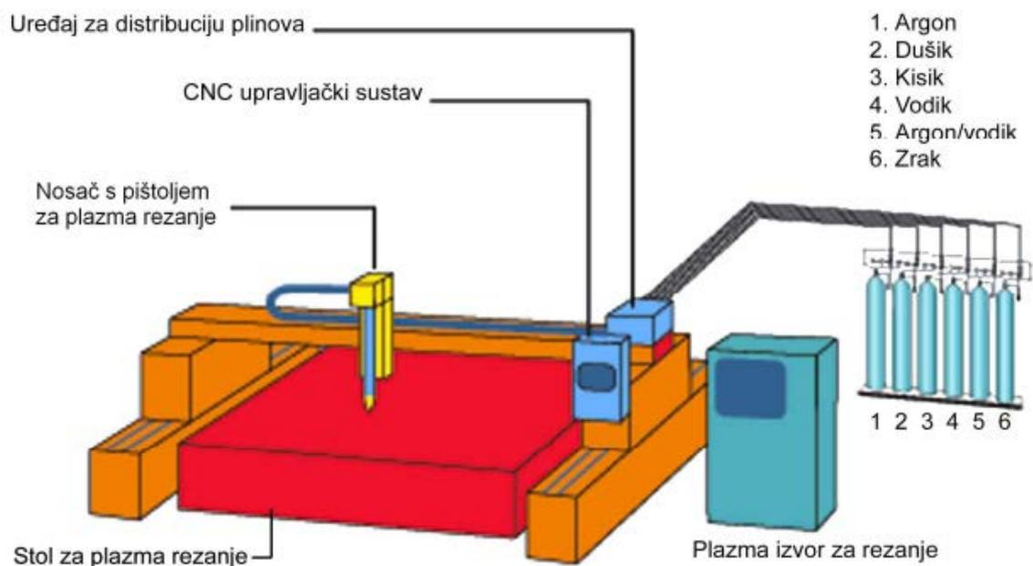
Slika 7. Komponente sustava strojnog rezanja plazmom [12]
