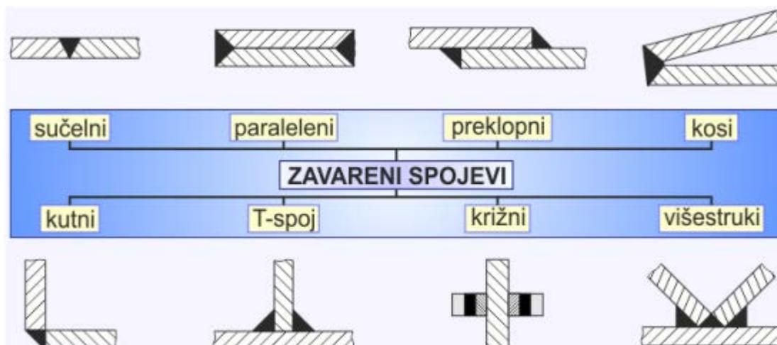
Slika 10. Vrste zavarenih spojeva [13]
