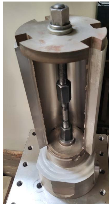
Slika 42. Naprava za stezanje (lijevo) i naprava zajedno sa stegnutim obradkom (desno) [28]
