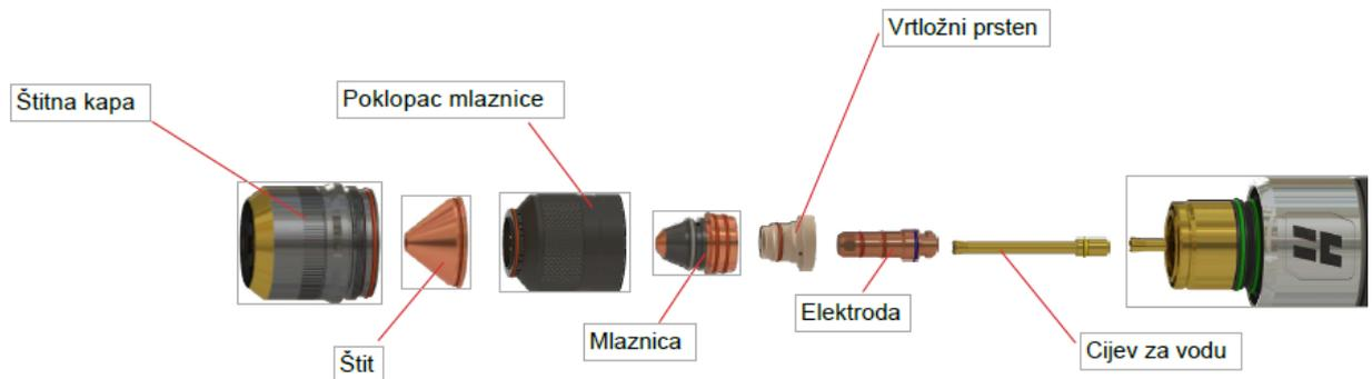
Slika 8. Prikaz dijelova pištolja za plazma rezanje [13]
