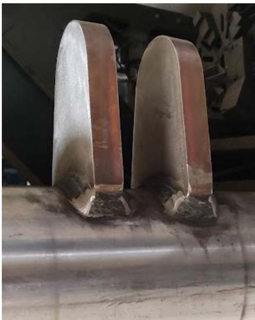
Slika 38. Kutni zavar po zatvorenoj konturi nakon čišćenja [28]
