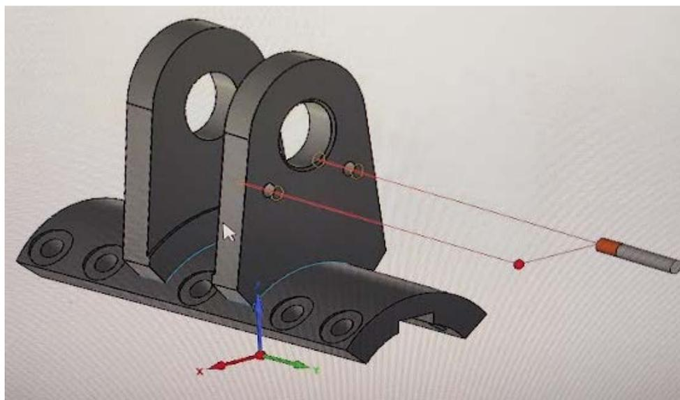
Slika 62. Simulacija bušenja provrta i urezivanja navoja [28]
