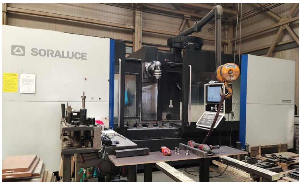
Slika 40. CNC glodači obradni centar Soraluce TA-A 25 [28]
