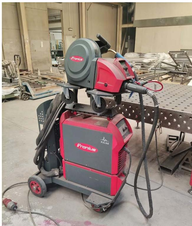
*Slika 36. Fronius TPS 320i uređaj za zavarivanje [28]*
