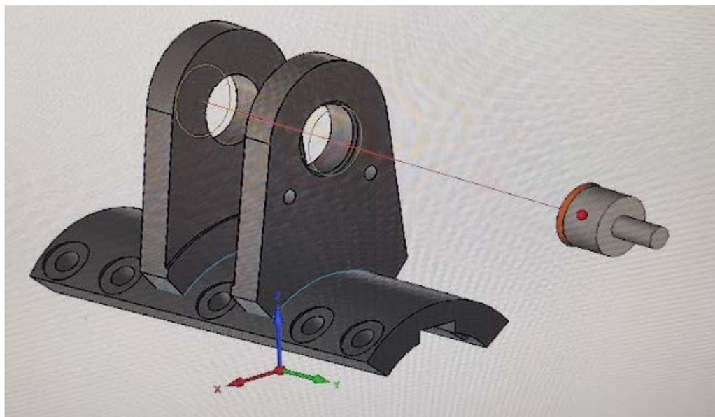
Slika 65. Simulacija finog istokarivanja provrta  $\phi 45$  H7 [28]
