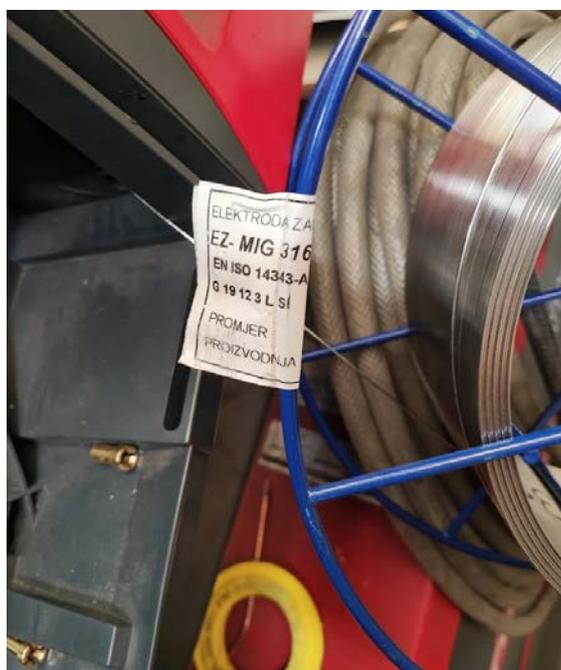
*Slika 37 Elektroda za zavarivanje EZ – MIG 316 LSi [28]*
