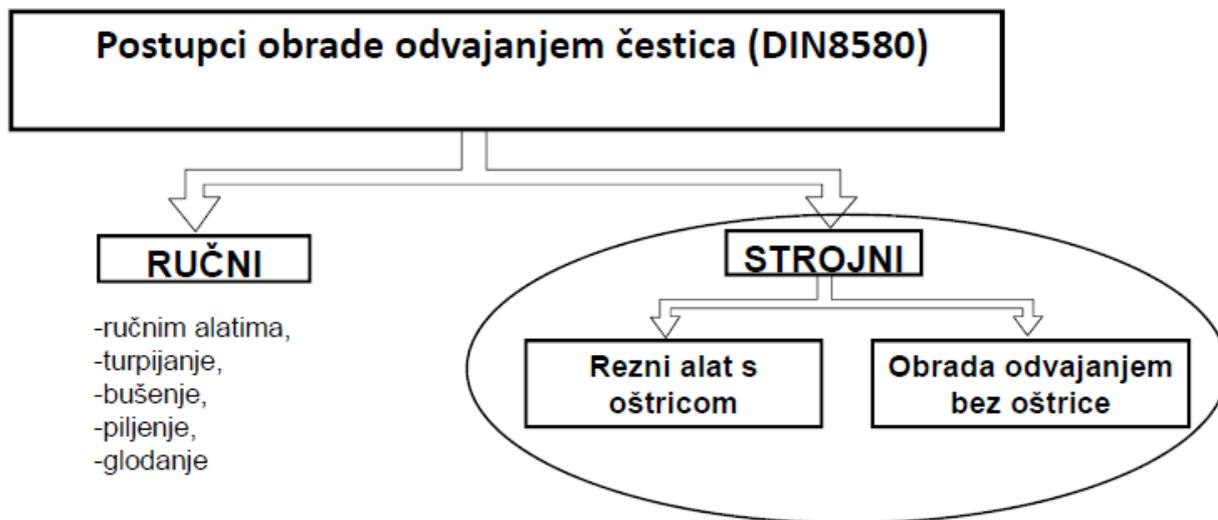
Slika 2. Postupci obrade odvajanjem čestica (DIN8580) [4]
