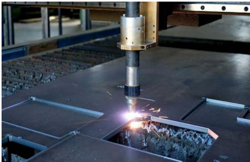
Slika 6. Prikaz plazma rezanja na CNC plazma rezaču [11]
