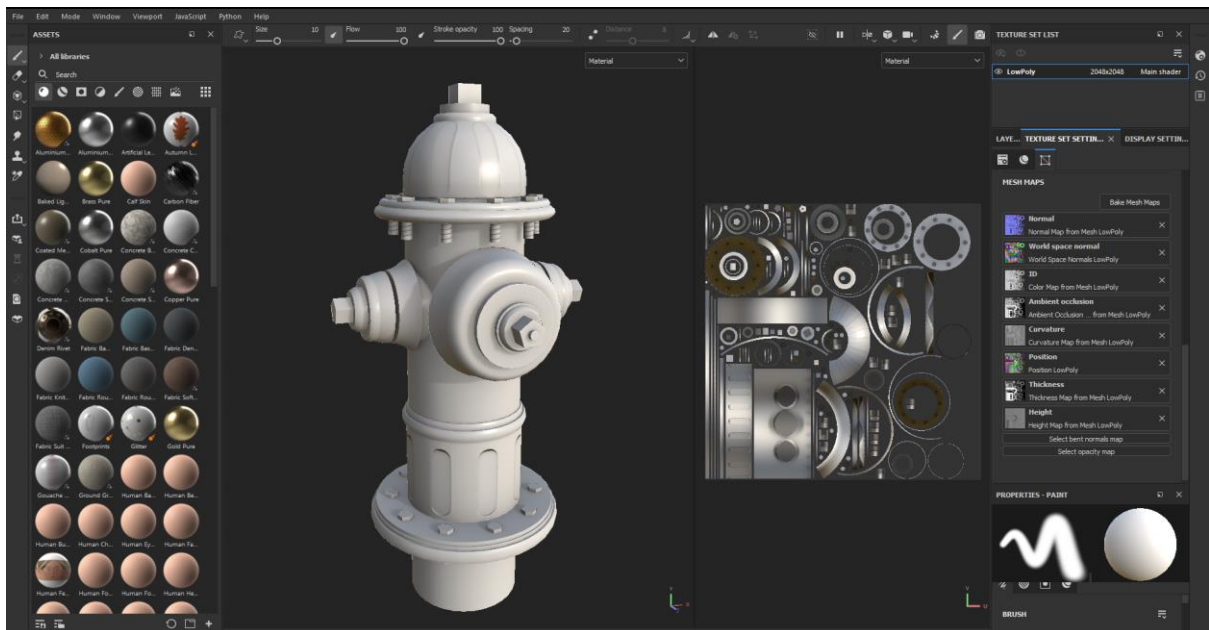
Slika 3.45 Prikaz Low Poly modela sa detaljima od High Poly modela
