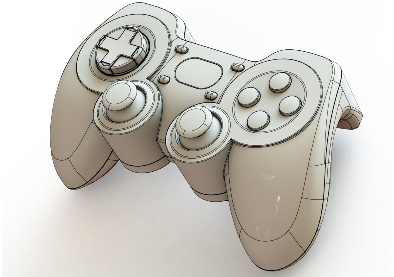
Slika 2.5 Prikaz 3D modela gaemepad-a modeliran NURBS tehnikom
