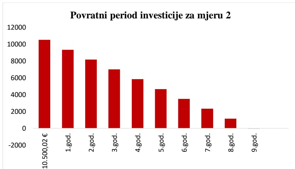
Prema povratnom periodu investicija mjere 2 odnosno ugradnja toplinske izolacije na vanjske zidove VZ1, VZ2 i VZ3 isplatila bi se za **9 godina** (tablica 25).
