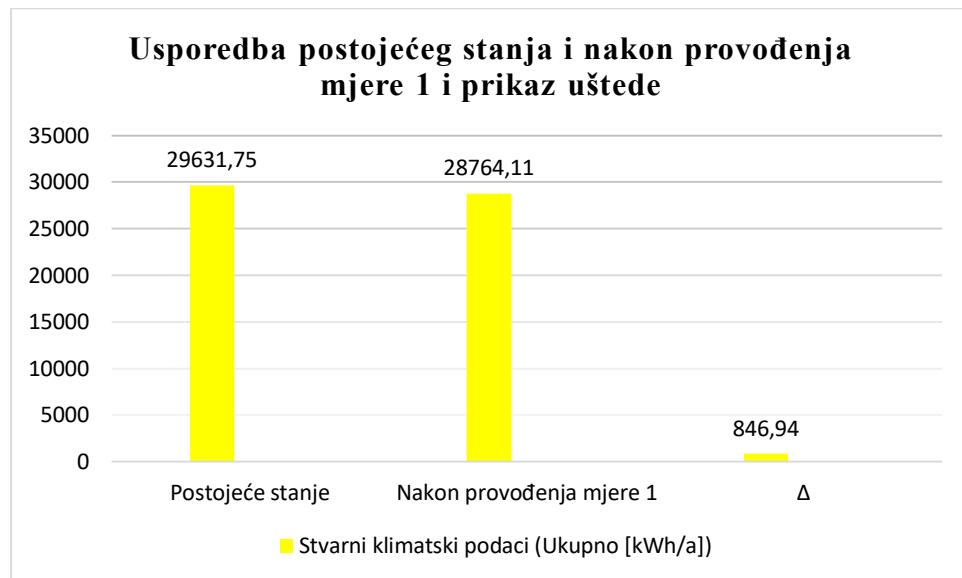
Nakon provedene mјere 1 godišnja ušteda prema stvarnim klimatskim podacima je  **$\Delta=846,94 \text{ [kWh/a]}$**  (tablica 19) te uz jediničnu cijenu plina **0,0598 €/kWh** ušteda iznosi **50,65€**
