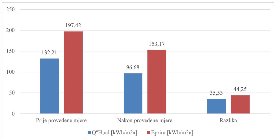
Slika 9. Usporedba potrebne energije prije i poslije provedene mjere 1. te ušteda
