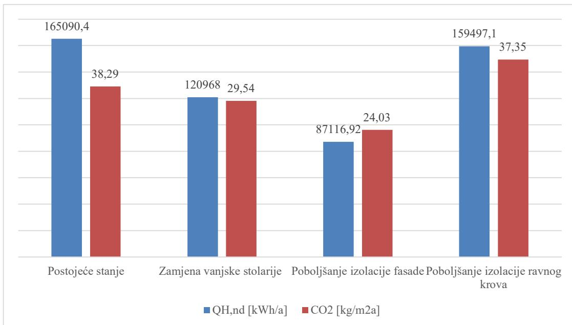
Slika 25. Usporedba potrebne energije za grijanje i emisija CO<sub>2</sub> svih predloženih mjera
