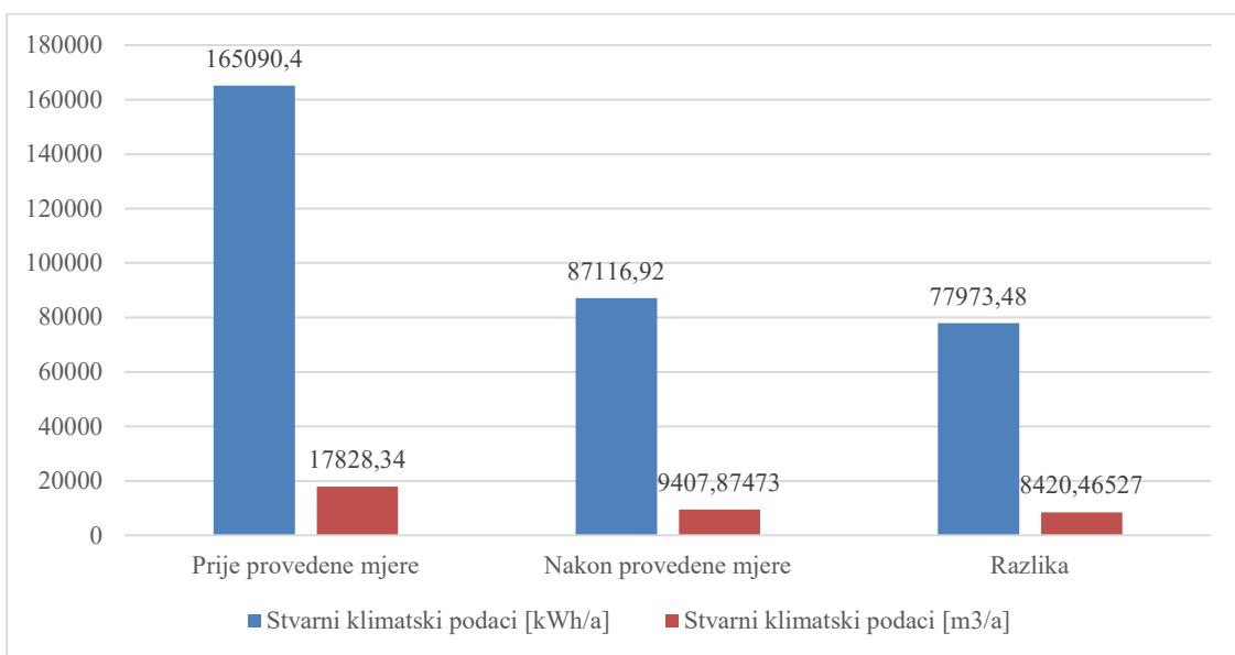
*Slika 14. Usporedba potrebne energije te ušteda nakon provedene mjeru 2. prema stvarnim klimatskim podacima*
