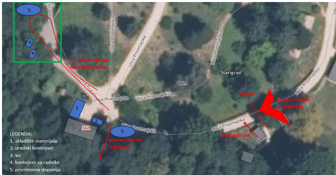
Slika 10.16. Shema uređenja gradilišta
