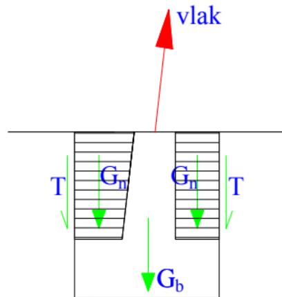
Vlačna sila dobivena je na modelu, a iznosi 161,76 kN
