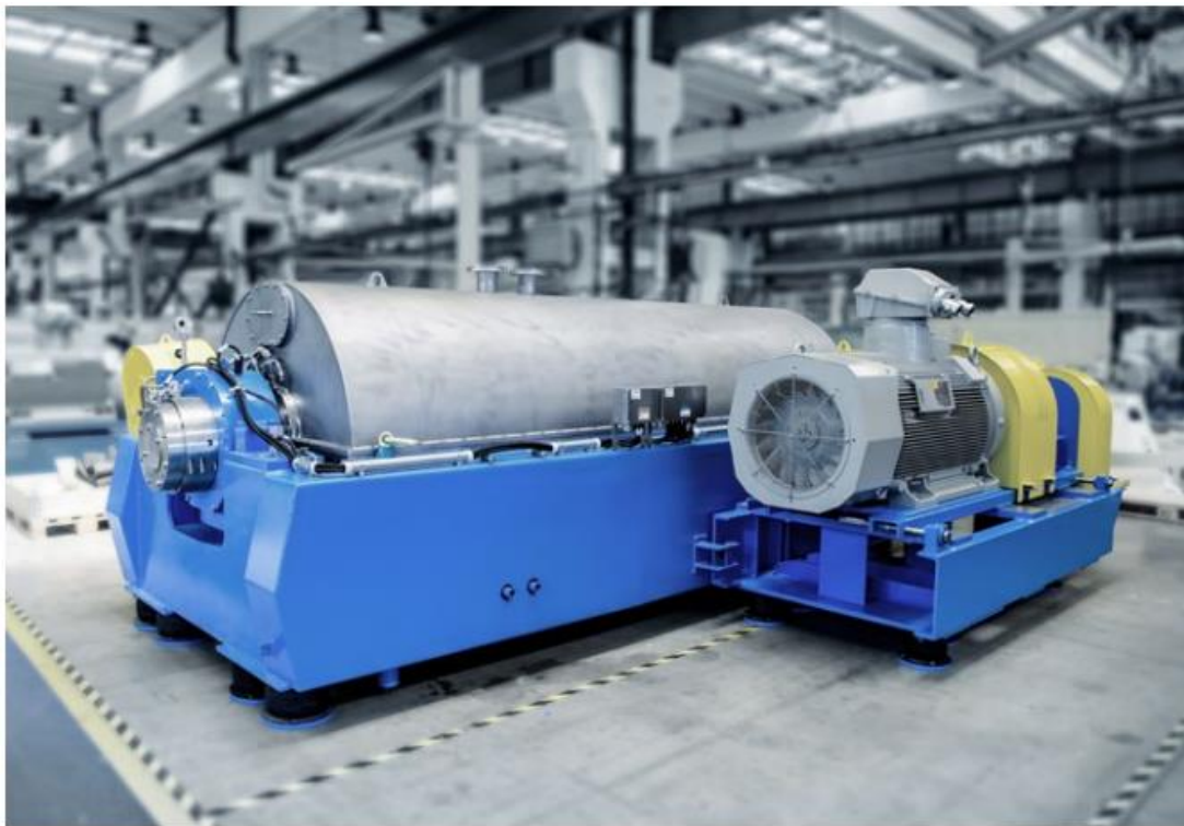
Slika 4. Centrifugalni stroj za recikliranje plastike [21]
