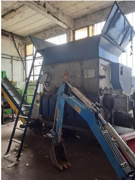
Slika 16. Stroj za mljevenje plastike
