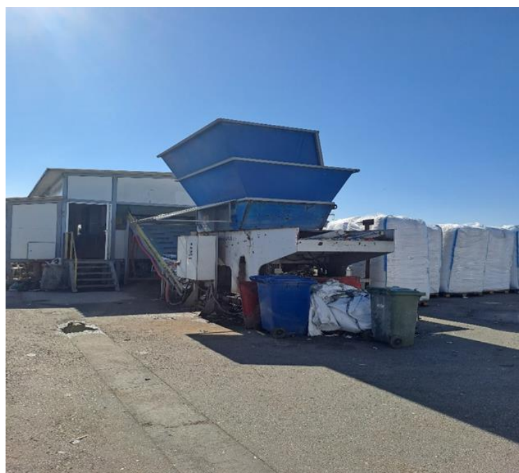
Slika 21. Uređaj za automatsko sortiranje (pellenc)
