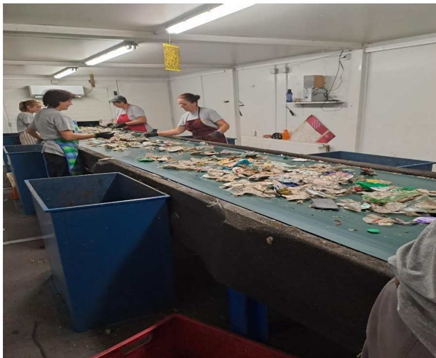
Slika 14. Horizontalna beskonačna transportna traka za sortiranje plastike
