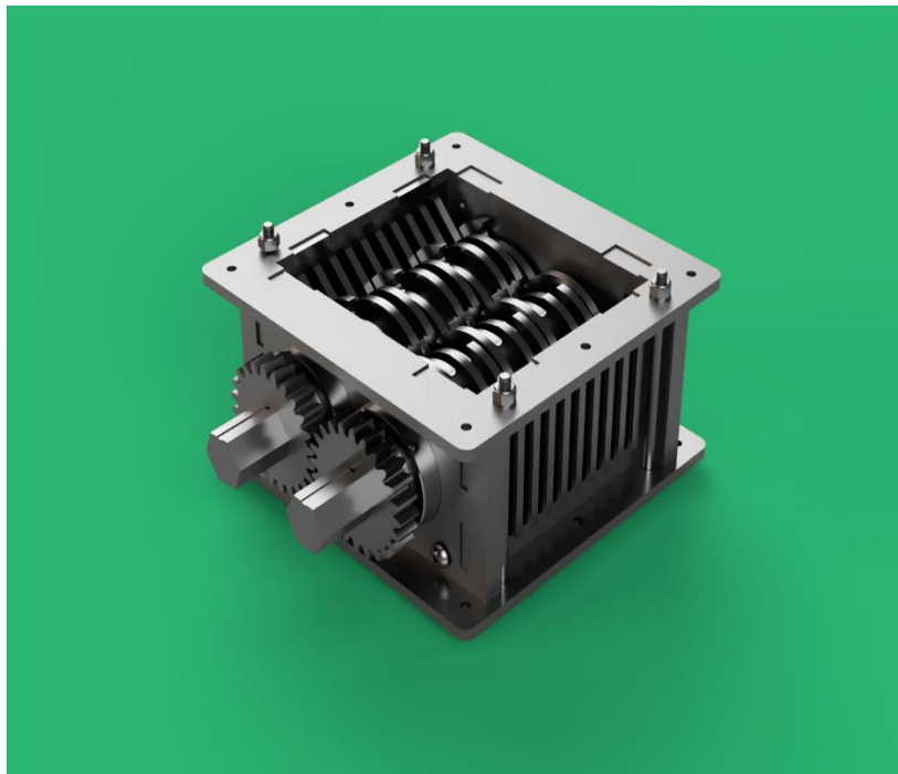
Slika 6. Stroj za mljevenje [14]
