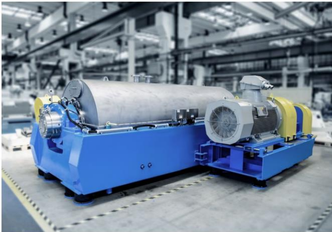
Slika 4. Centrifugalni stroj za recikliranje plastike [21]
