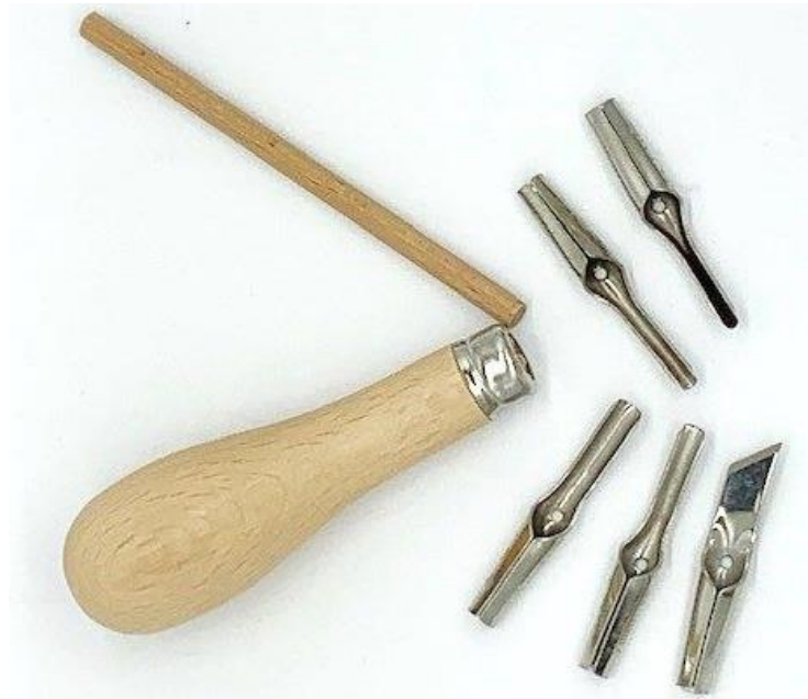
Slika 18. Nožići, alat za rezanje linoreza
