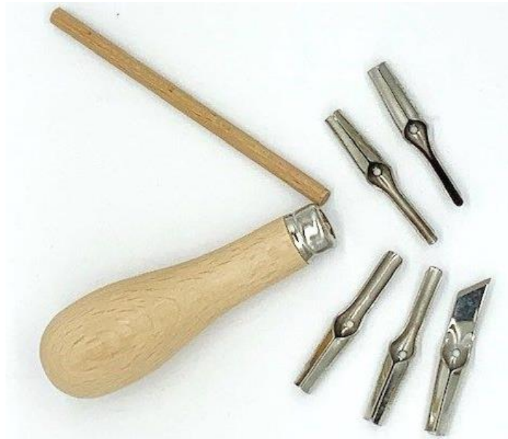
Slika 18. Nožići, alat za rezanje linoreza
