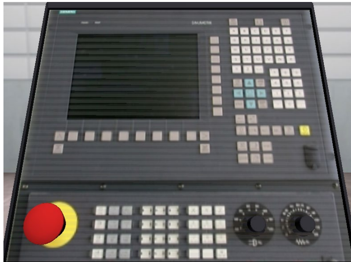
Slika 1.2 CNC upravljačka jedinica Siemens Sinumerik 840D [3]
