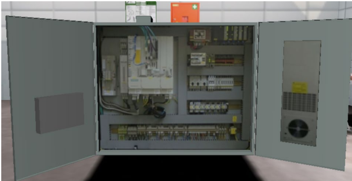
Slika 2.5 Upravljački ormar CNC stroja [3]
