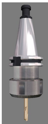
Slika 3.5 Alat za glodanje utora promjera 10 mm [2]
