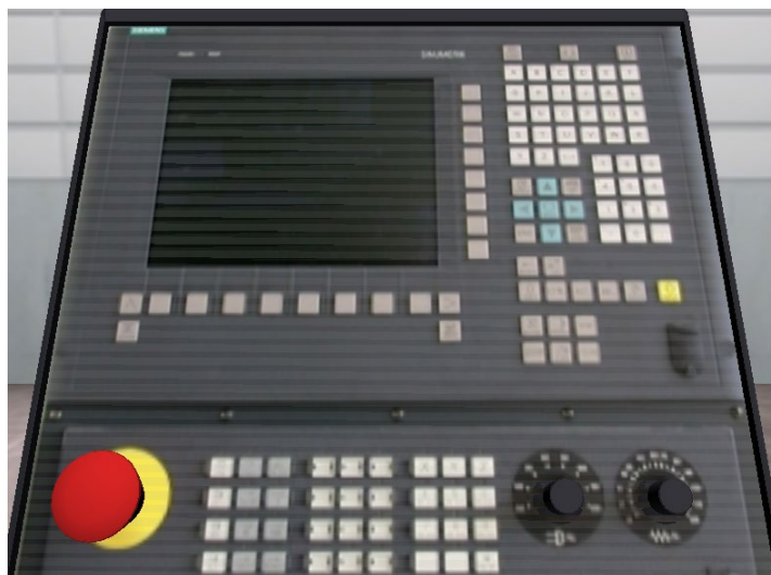
Slika 1.2 CNC upravljačka jedinica Siemens Sinumerik 840D [3]
