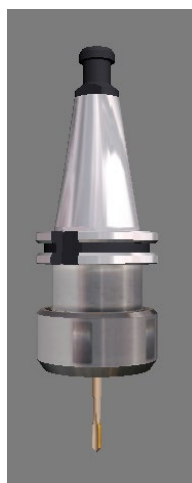
Slika 3.7 Alat za urezivanje navoja M10 [2]
