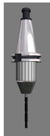
Slika 3.6 Alat za bušenje promjera 8.5 mm [2]
