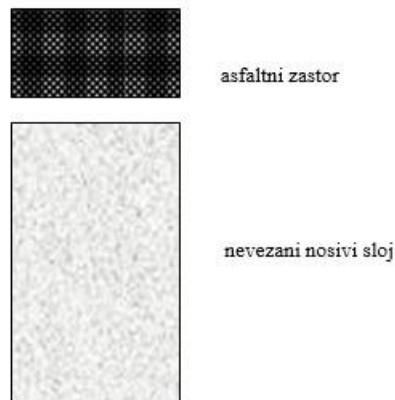
Slika 4.18: Asfaltna kolnička konstrukcija sa nosivim slojem od nevezanog kamenog agregata (Žmavc, 2005)
