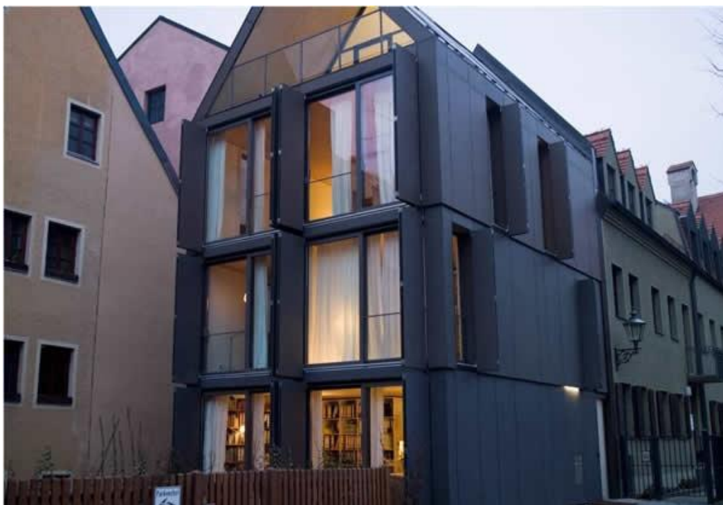
Slika 6.1. Vlkanocementne ploče za ventilirane fasade
