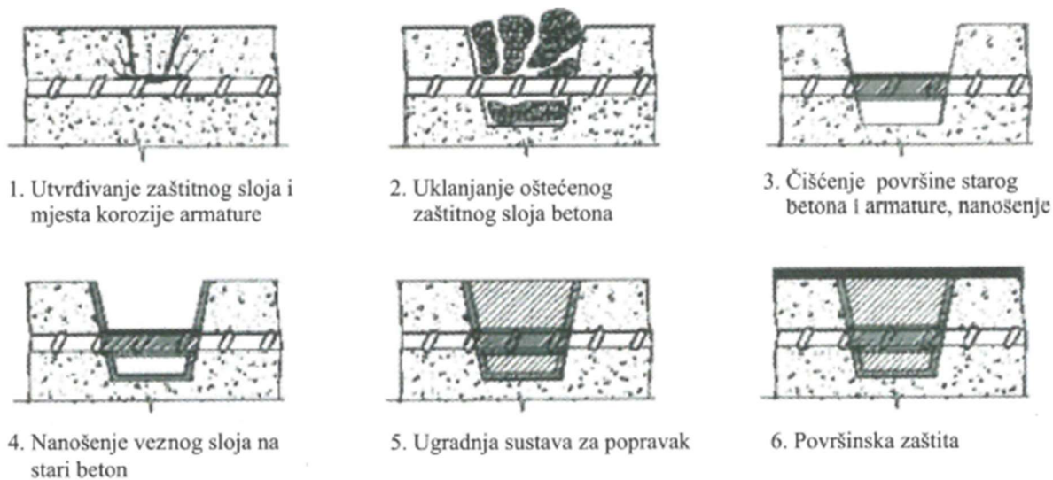
Slika 15: Osnovne faze popravka zaštitnog sloja
