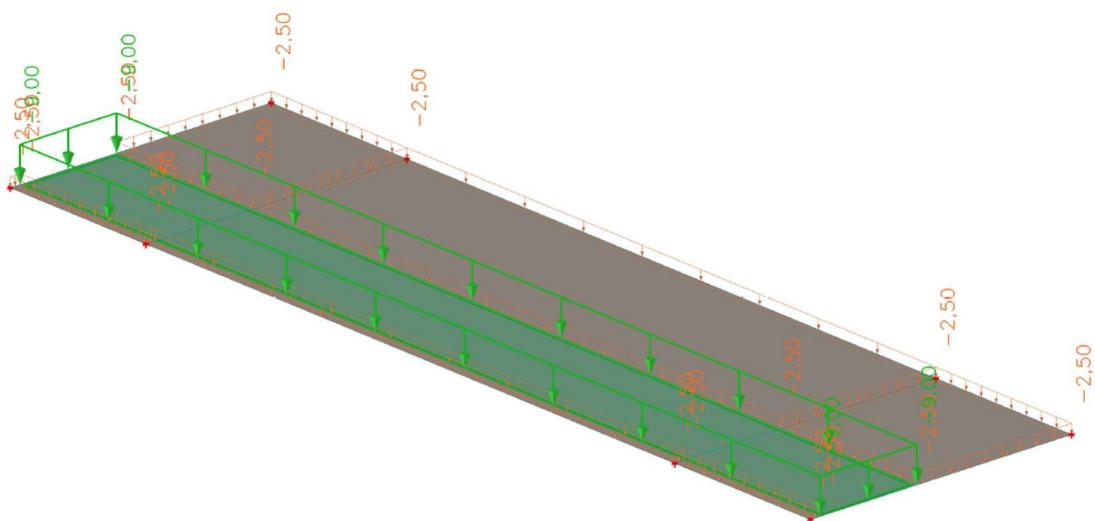
Slika 32: Prikaz kontinuiranog opterećenja
