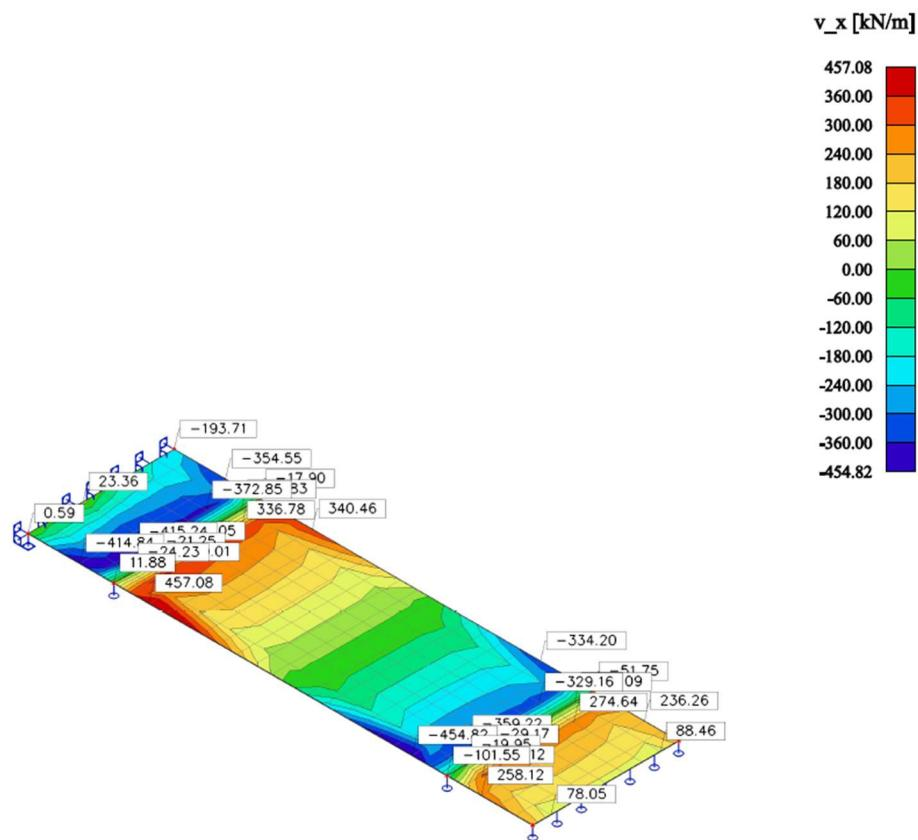
Slika 40: Iznosi poprečnih sila
