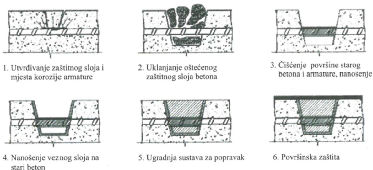
Slika 15: Osnovne faze popravka zaštitnog sloja
