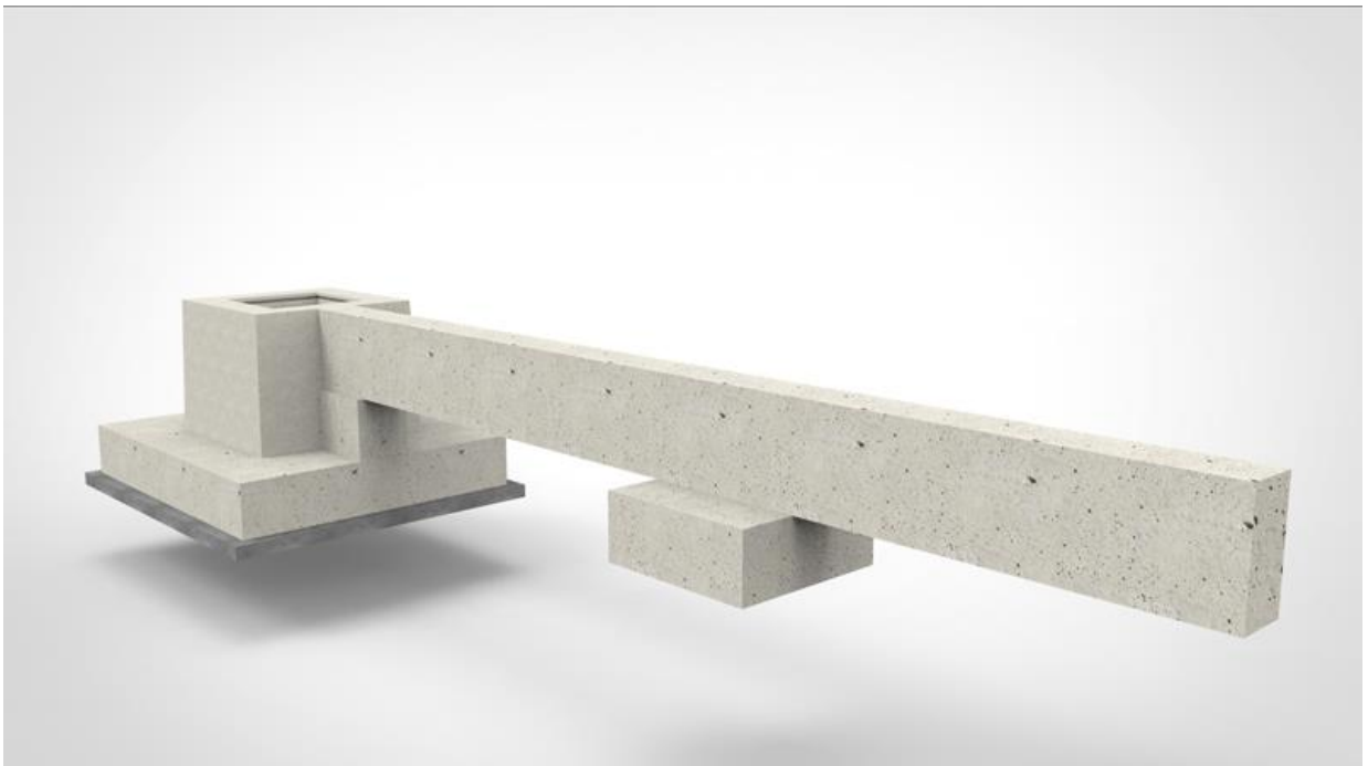
Slika 4.1 Prikaz spoja temeljne grede i čaišice
