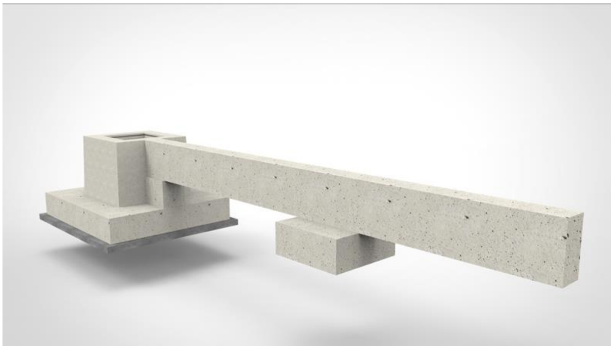
Slika 4.1 Prikaz spoja temeljne grede i čaišice
