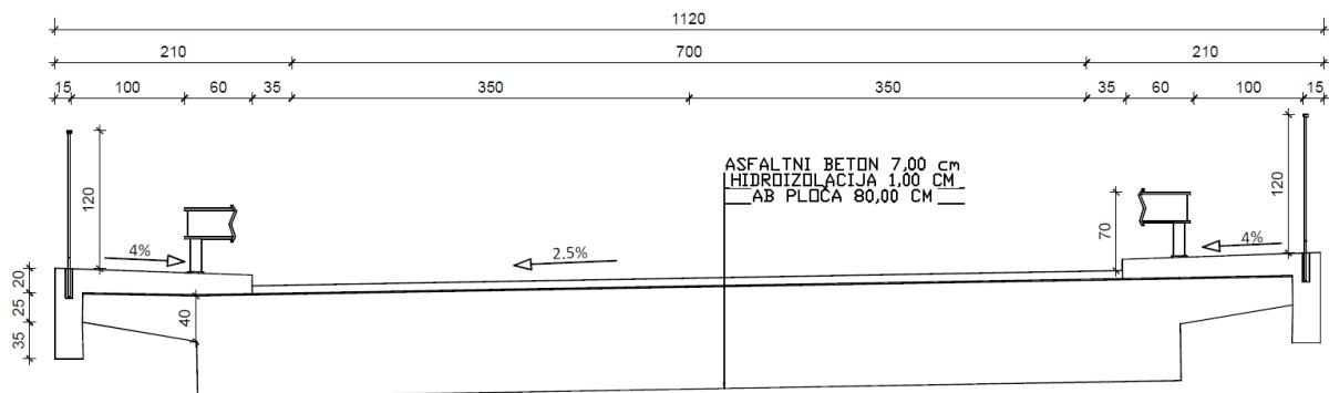
Slika 3.2 Poprečni presjek glavnog nosača nadvožnjaka (Izvor: Autor)
