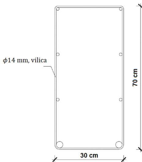
Zbog stabilnosti koša armature kod betoniranja se ugrađuju minimalno 4 vilice po  $m^2$  površine. U poprečnom smislu na svim dijelovima dolazi min. 2 komada vilica na 1 m širine.
