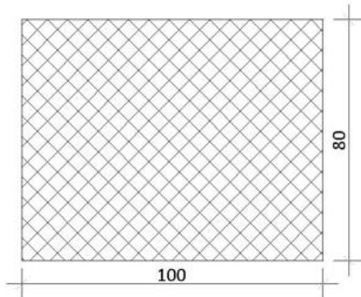
*Slika 4.2 Poprečni presjek štapnog nosača (Izvor: Autor)*
