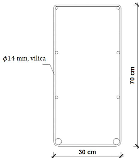
Zbog stabilnosti koša armature kod betoniranja se ugrađuju minimalno 4 vilice po  $m^2$  površine. U poprečnom smislu na svim dijelovima dolazi minimalno 2 komada vilica na 1,00 m širine. Rub sa svake strane ploče se u uzdužnom smislu ojačava s vilicama na razmaku 20 cm po cijeloj dužini nosača.
