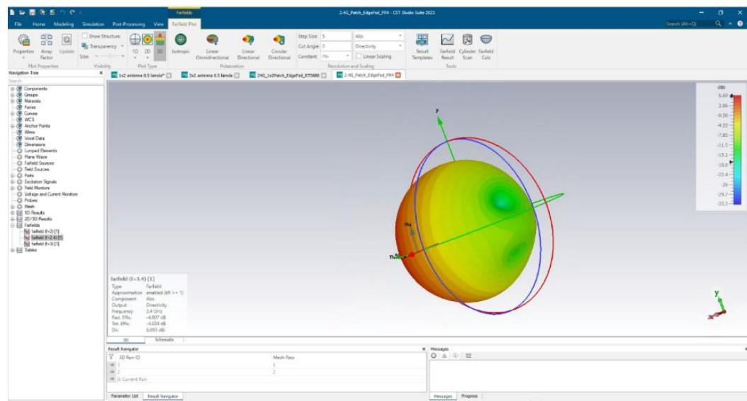
Slika 8.5: 3D dijagram zračenja u dalekom polju, 2,4 GHz (usmjerenoš 6,69 dBi, dobitak 1,79 dBi)
