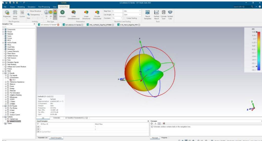
Slika 8.10: 3D dijagram zračenja u dalekom polju, 1x2 3,6 GHz (usmjerenoš 9,92 dBi, dobitak 9,68 dBi)
