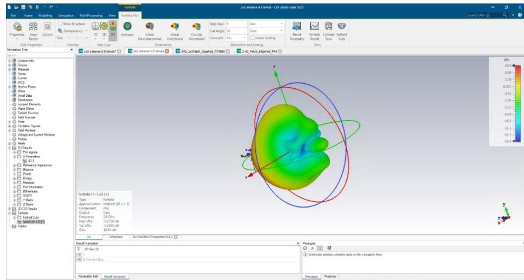
Slika 8.15: 3D dijagram zračenja u dalekom polju, 2x2 3,6 GHz (usmjerenost 10,90 dBi, dobitak 10,63 dBi)
