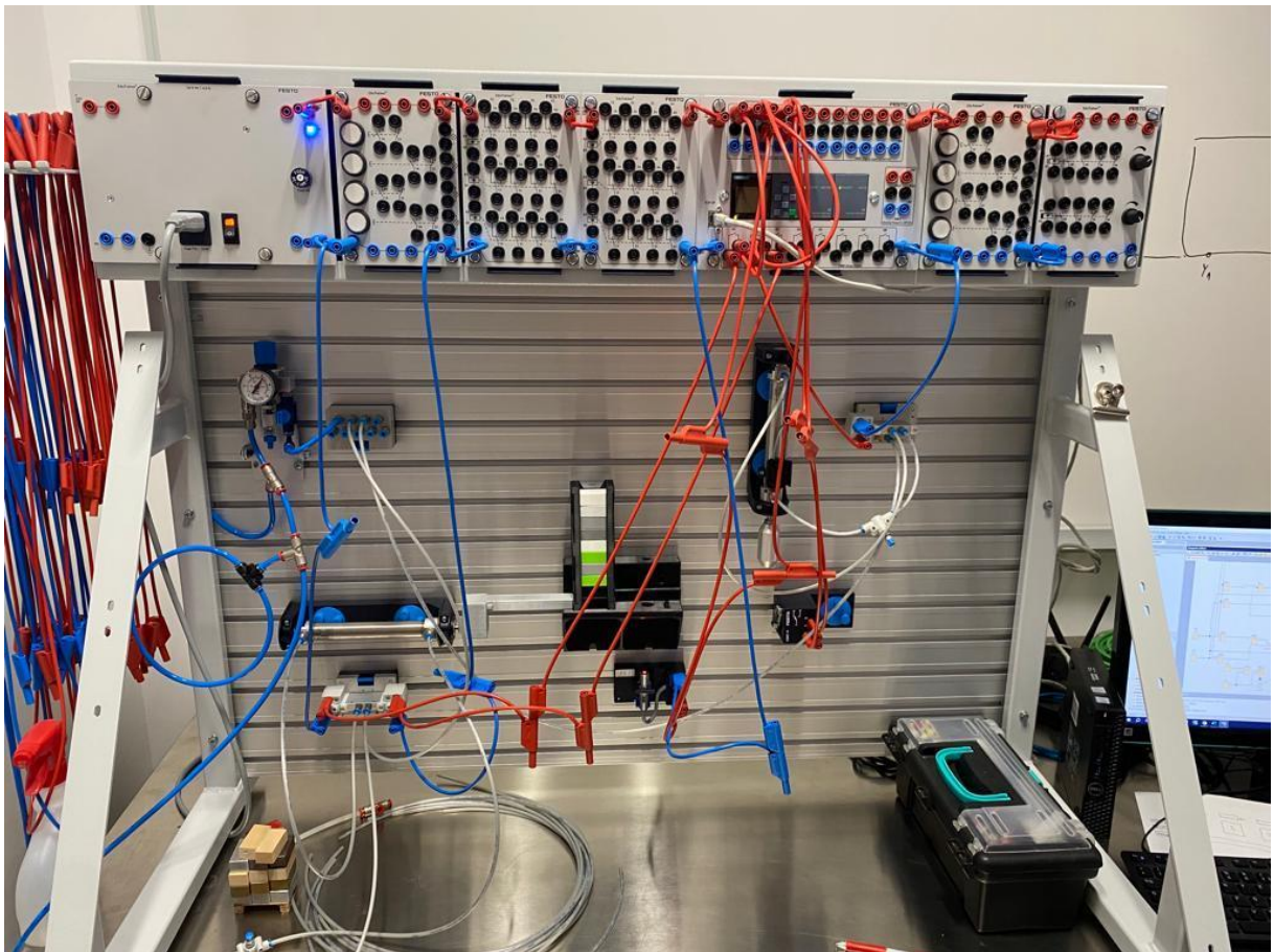
Slika 2 Proces upravljan LOGO! logičkim modulom i WEB serverom
