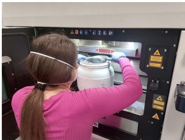
Slika 21 - Punjenje spremnika prahom
