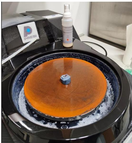
*Slika 41 - Poliranje s  $9 \mu m$*
