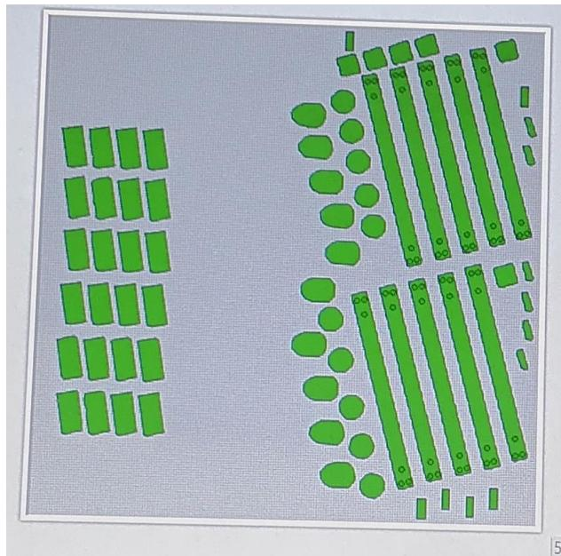
Slika 17 - Prikaz rasporeda komada na radnoj ploči
