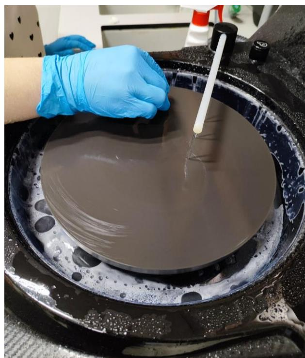
Slika 37 - Brušenje uzorka
