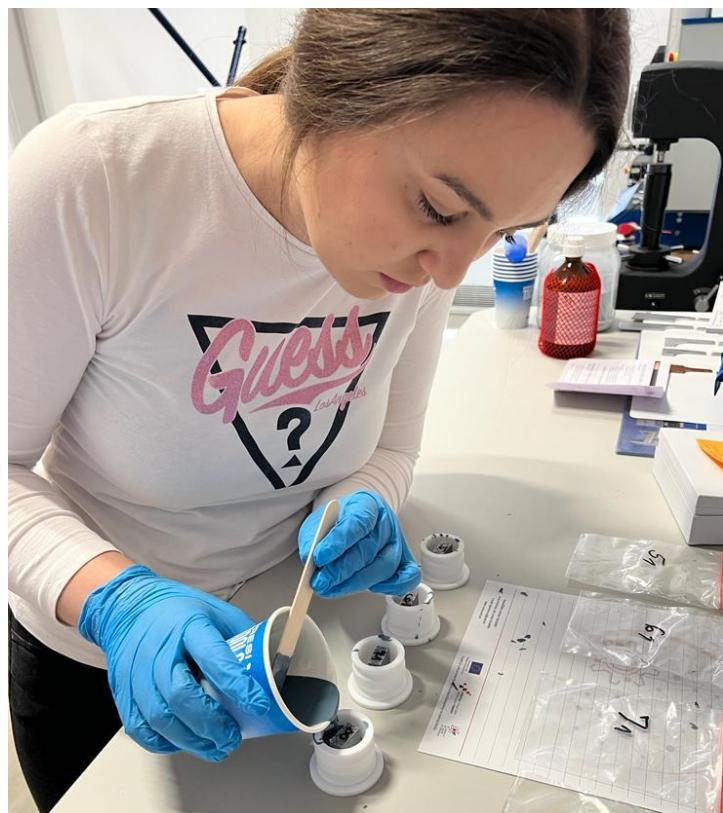
Slika 33 - Zalijevanje uzorka polimernom masom
