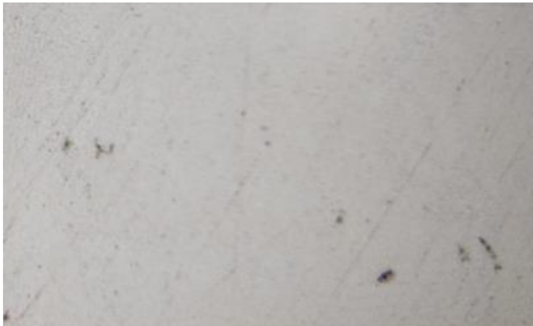
Slika 40 – Površina uzorka nakon brušenja s granulacijom P1200
