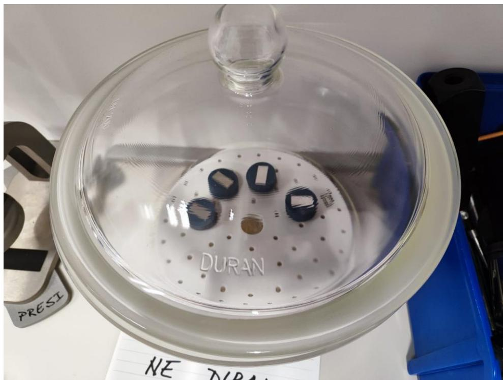
Slika 35 - Čuvanje uzorka u laboratorijskom eksikatoru
