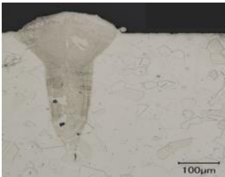
Slika 11 – Greške u mikrostrukтури tipa „Keyhole“ [7]
