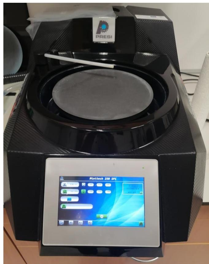
Slika 36 - 'Presi' uređaj za poliranje i brušenje
