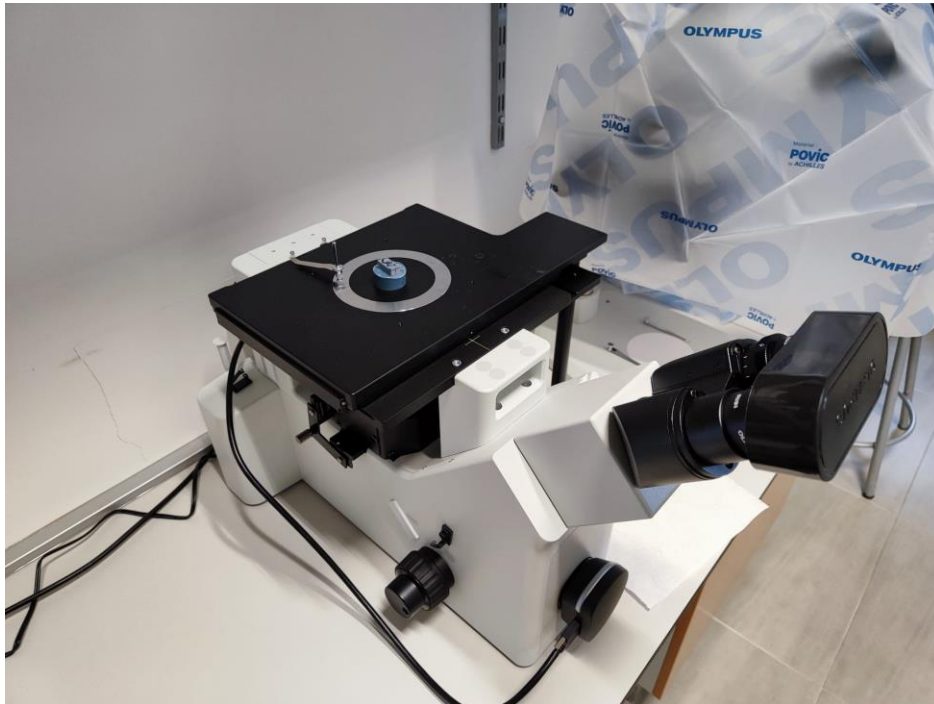
Slika 48 - Svjetlosni mikroskop Olympus GX53F-5
