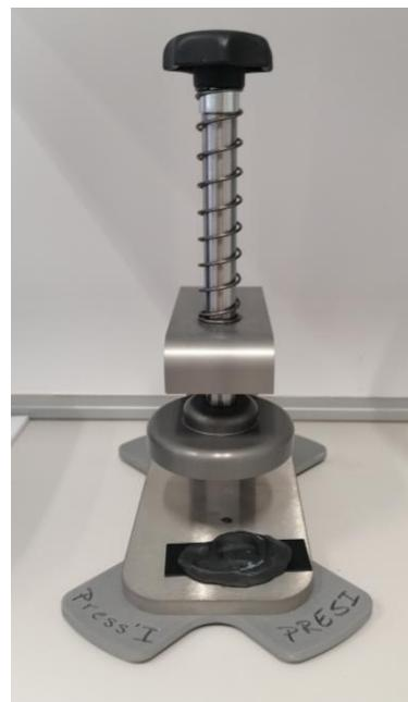
Slika 51 - Preša za niveliranje uzorka
