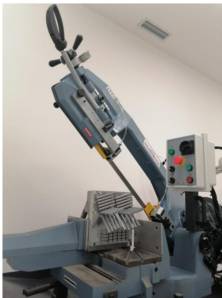
Slika 29 - Tračna pila za metal CY210A, Farrox
