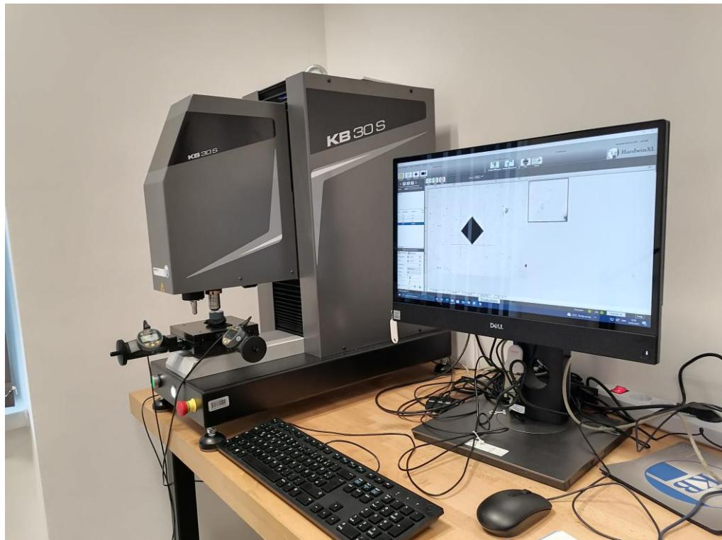
Slika 52 - Mikrotvrdomjer
