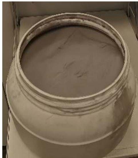
*Slika 18-Metalni prah AlSi10Mg*
