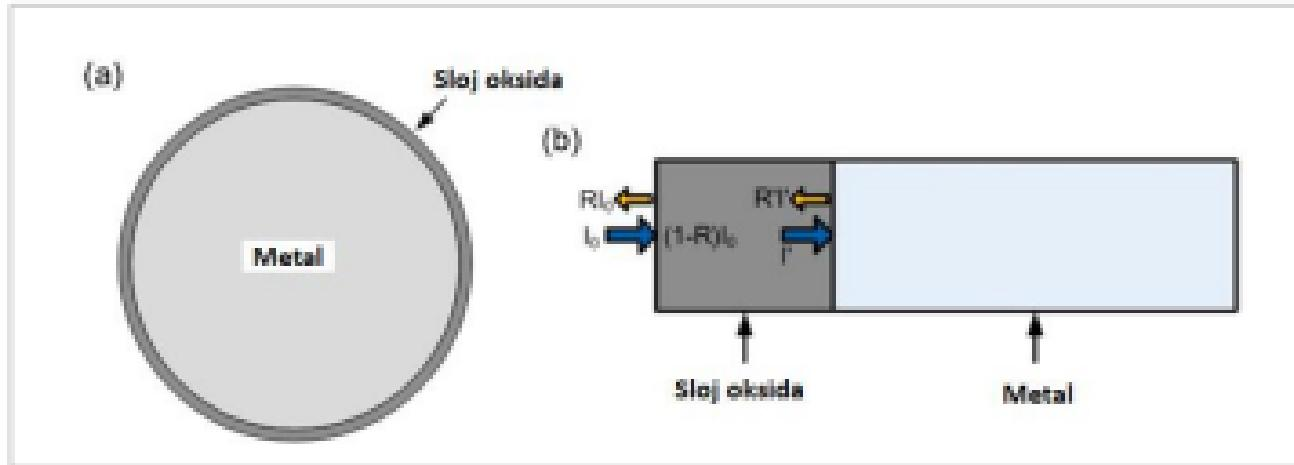
Slika 8 – Apsorbancija kod čestice metalnog praha [9]
