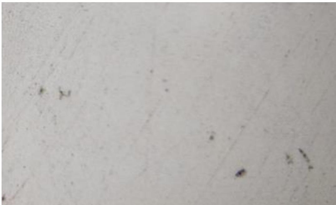
*Slika 40 – Površina uzorka nakon brušenja s granulacijom P1200*
