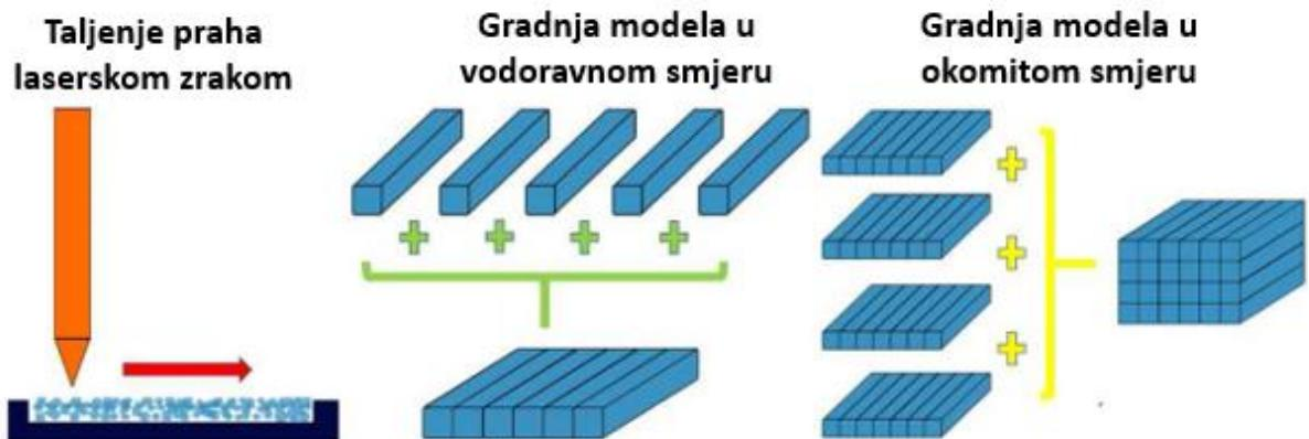
Slika 2 - Taljenje praha kod SLM postupka [1]
