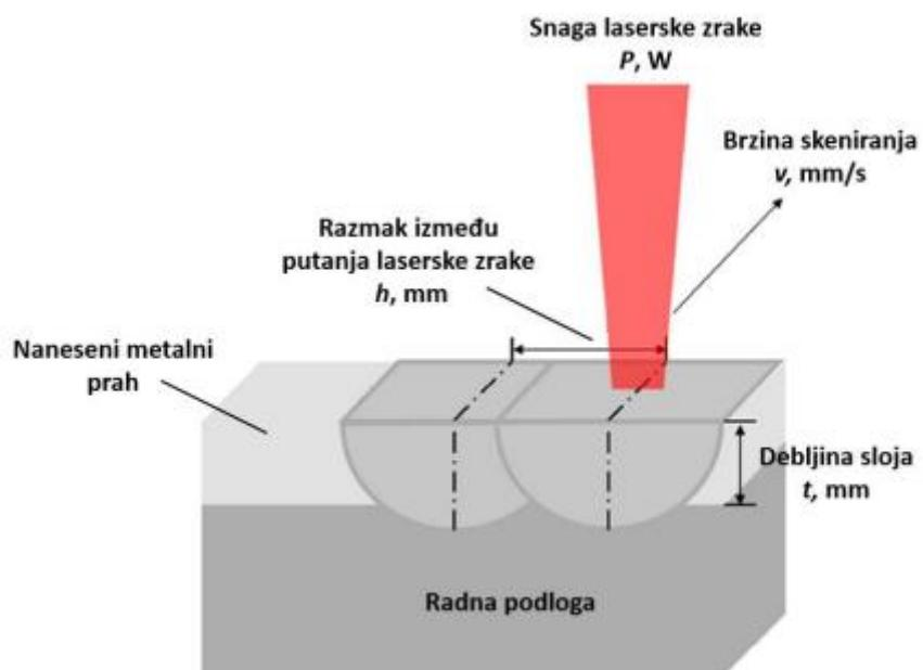
Slika 13 - Shematski prikaz glavnih parametara SLM postupka [9]
