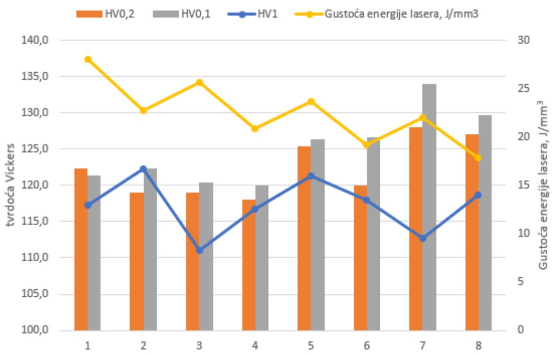
*Slika 53 - Mikrotvrdoća ispitanih uzoraka*
