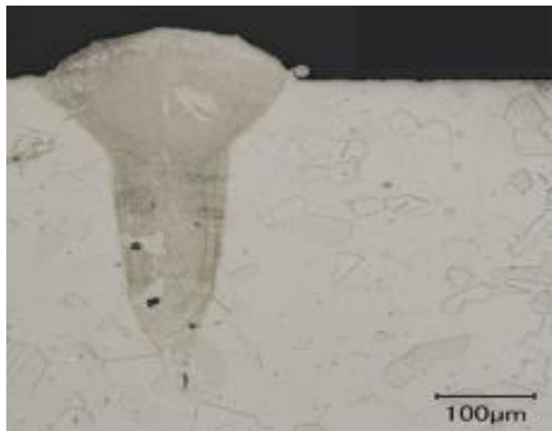
Slika 11 – Greške u mikrostrukturi tipa „Keyhole“ [7]
