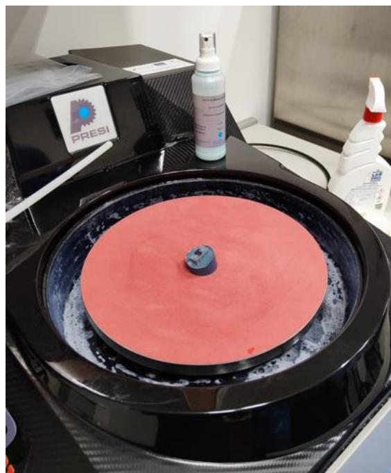
*Slika 43 - Poliranje s 1 µm*
