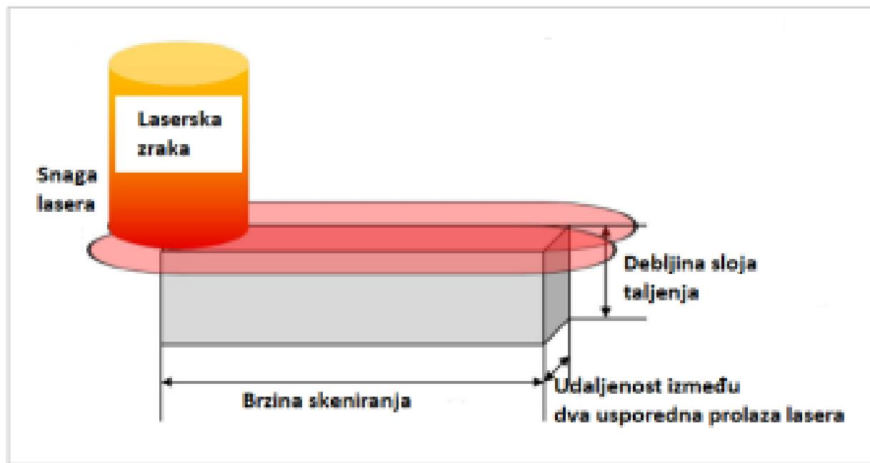
Slika 14 – Shematski prikaz SLM postupka [9]
