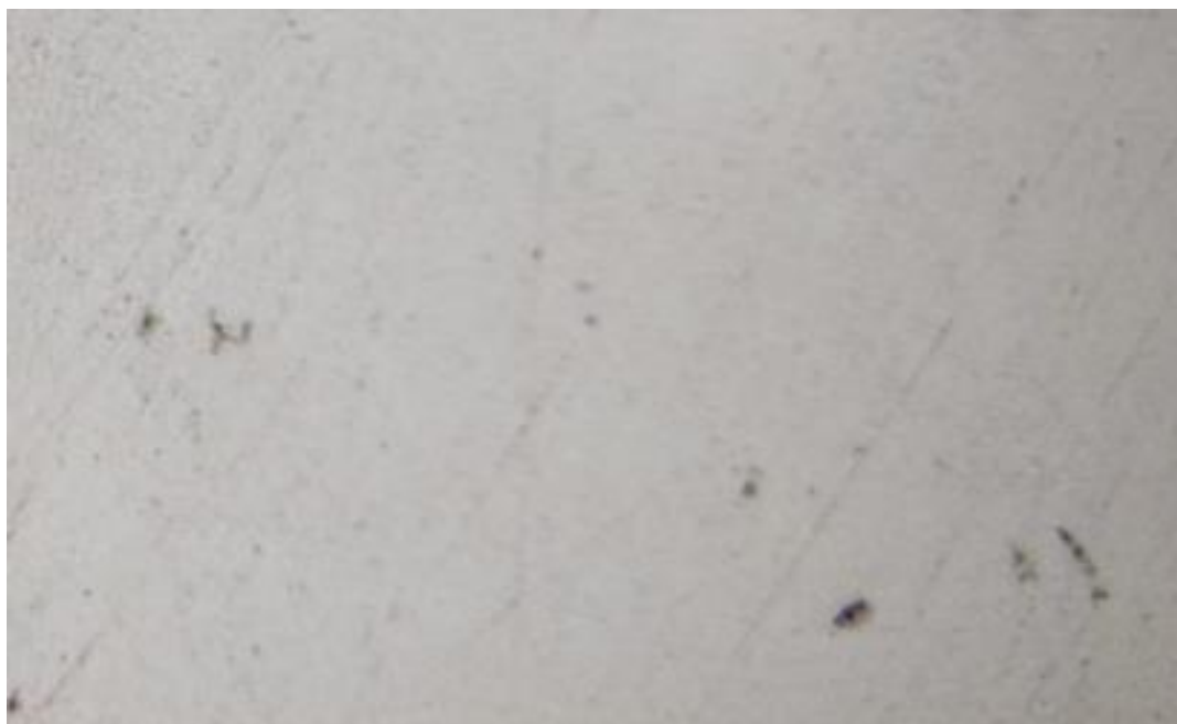
Slika 40 – Površina uzorka nakon brušenja s granulacijom P1200
