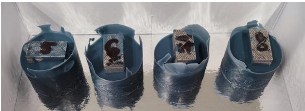
Slika 34 - Označavanje uzoraka markerom
