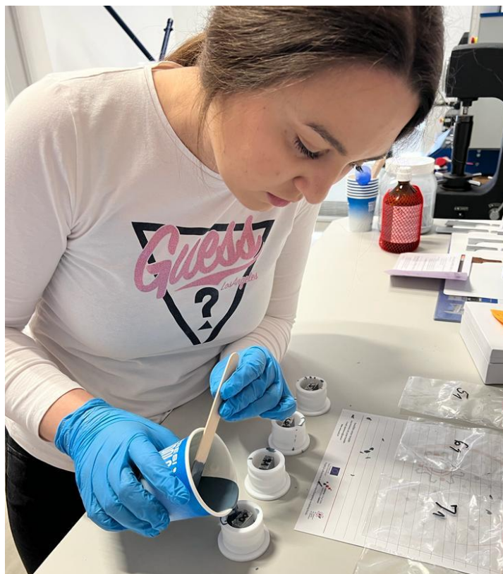
Slika 33 - Zalijevanje uzoraka polimernom masom
