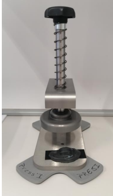
Slika 51 - Preša za niveliranje uzorka
