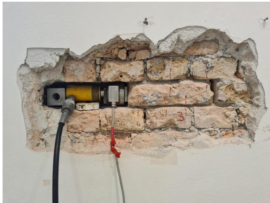
Slika 8. Ispitivanje posmične čvrstoće zida in situ
