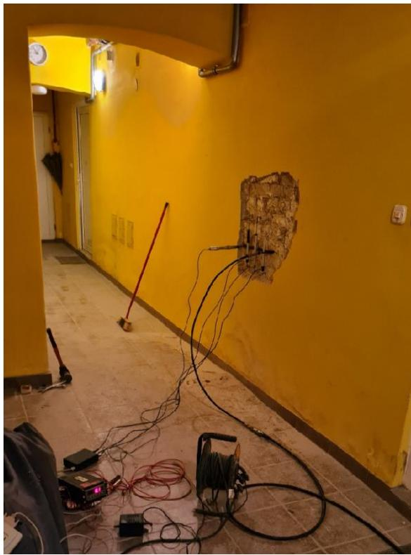
Slika 19. Određivanje postojećeg tlačnog naprezanja u zidu
