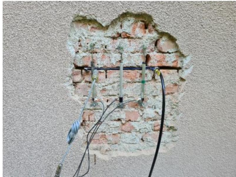
Slika 18. Određivanje postojećeg tlačnog naprezanja u zidu
