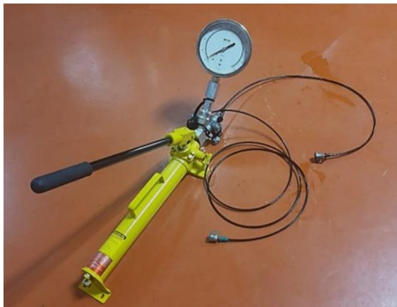
Slika 13. Hidraulični sustav za nanošenje tlaka [6]
