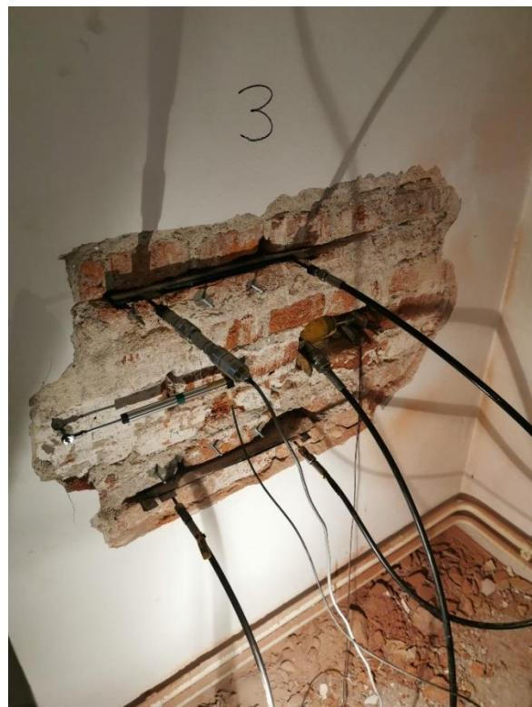
Slika 20. Ispitivanje posmične čvrstoće uz kontrolu vertikalnog naprezanja
