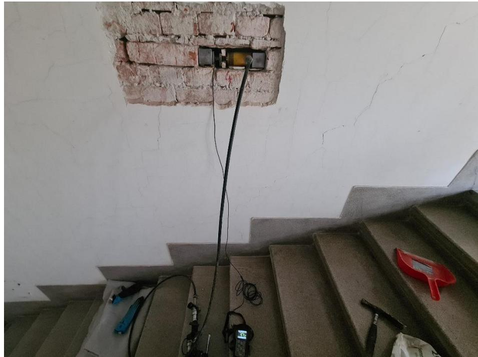
Slika 10. Ispitivanje posmične čvrstoće ziđa in situ
