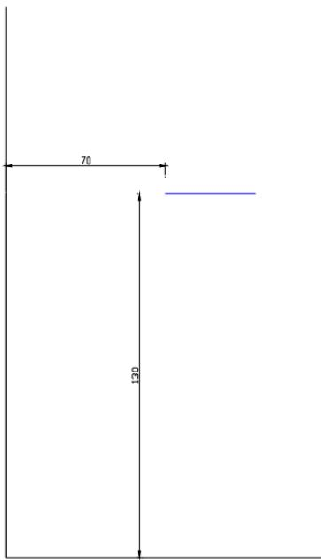
*Slika 58. Pozicija ispitivanja u odnosu na kut zgrade*
