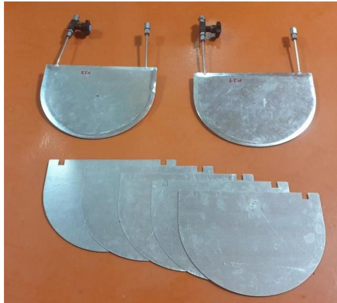
Slika 12. Plosnate preše i čelične podložne ploče [6]
