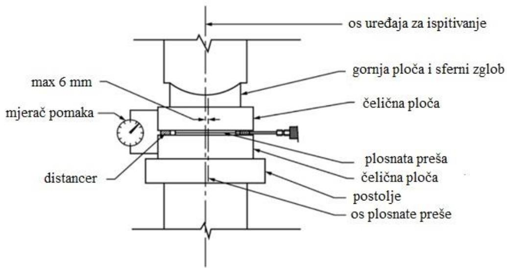
Slika 16. Shematski prikaz kalibracije plosnate preše [8]
