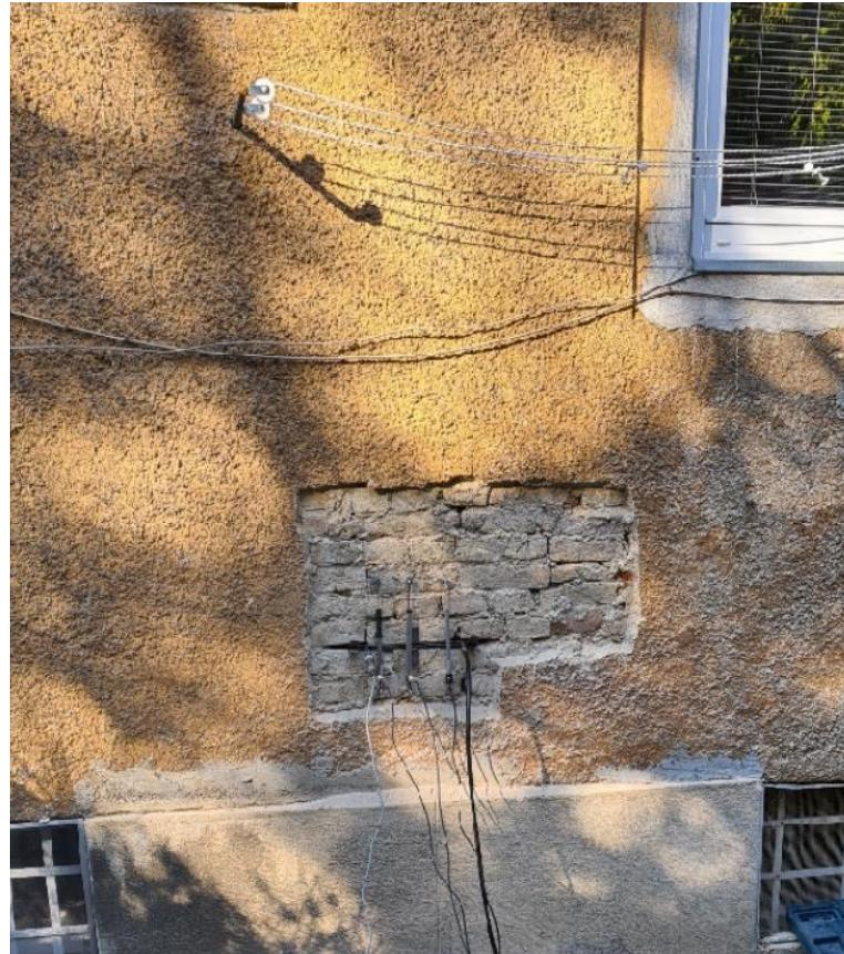
Slika 17. Određivanje postojećeg tlačnog naprezanja u ziđu
