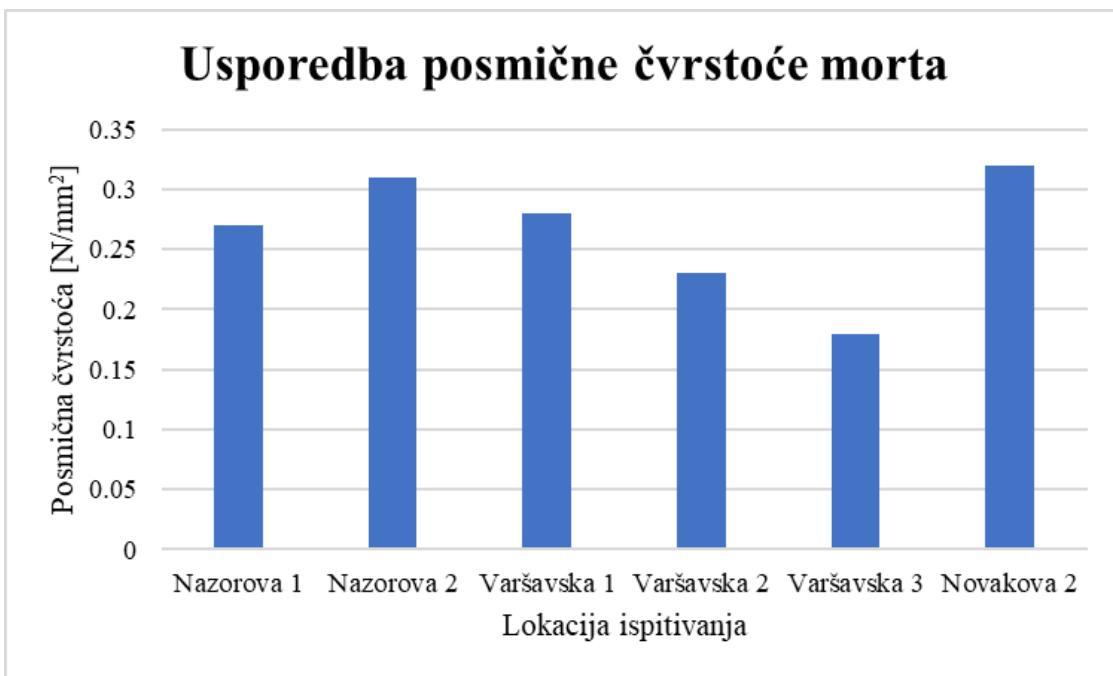
*Slika 68. Grafički prikaz usporedbe posmične čvrstoće morta*
