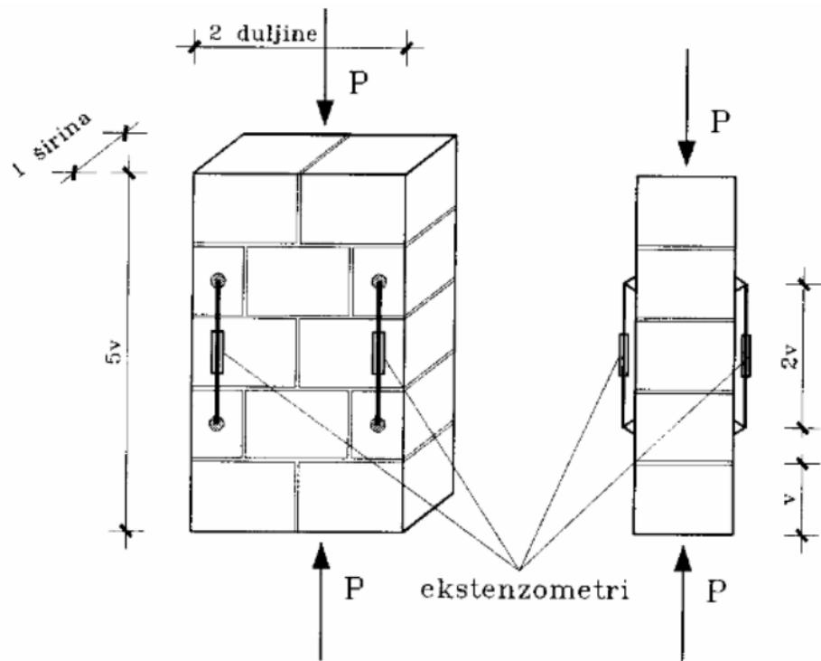
Slika 4. Eksperimentalno određivanje tlačne čvrstoće ziđa [5]
