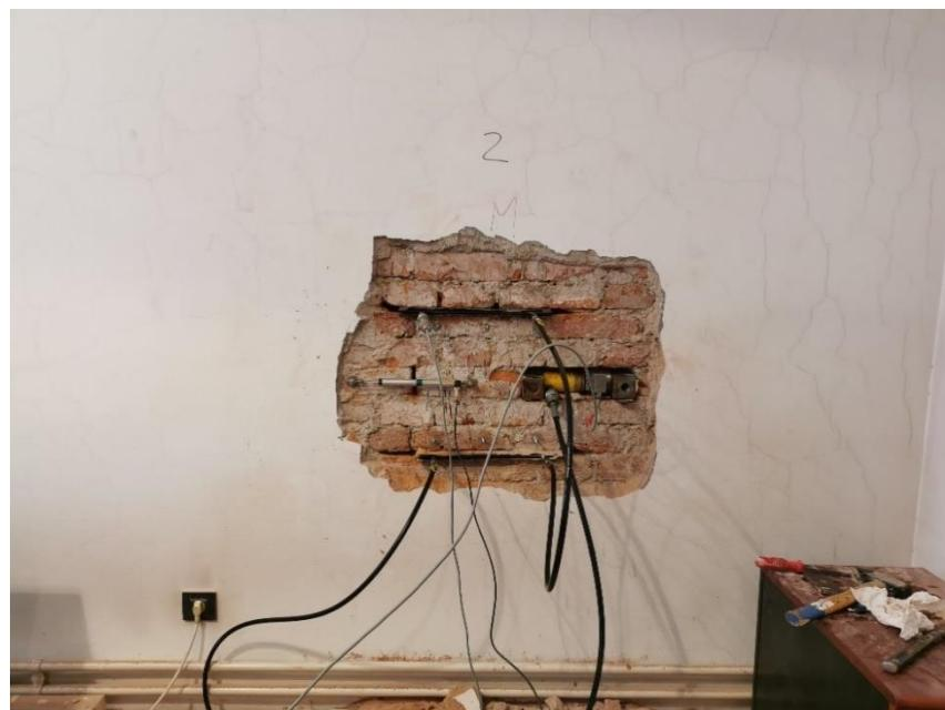
Slika 21. Ispitivanje posmične čvrstoće uz kontrolu vertikalnog naprezanja
