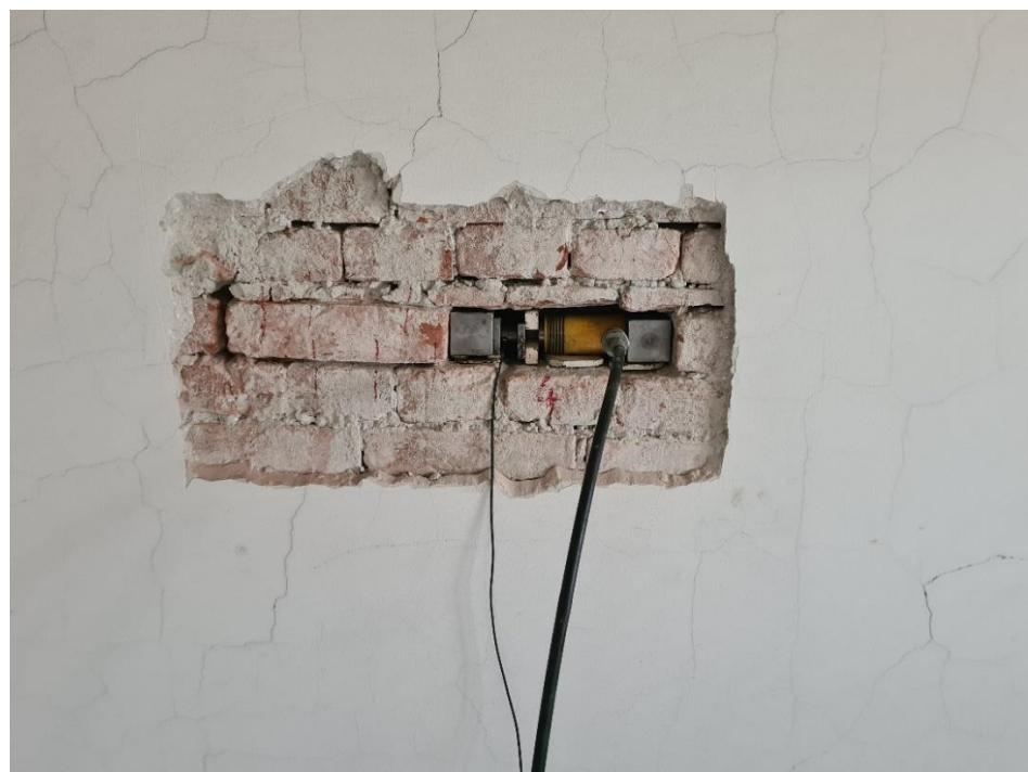
Slika 9. Ispitivanje posmične čvrstoće ziđa in situ
