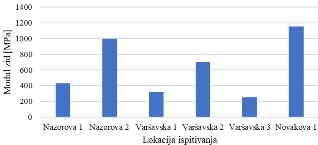
Slika 67. Grafički prikaz usporedbe deformabilnosti zidâ
