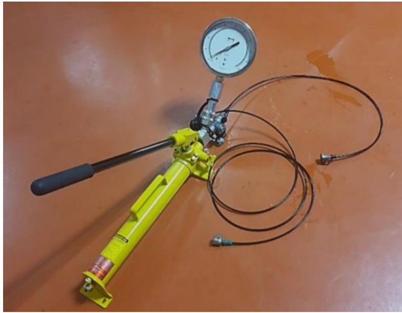
Slika 13. Hidraulični sustav za nanošenje tlaka [6]
