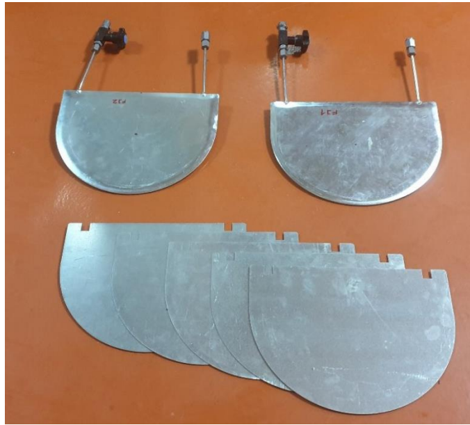
Slika 12. Plosnate preše i čelične podložne ploče [6]
