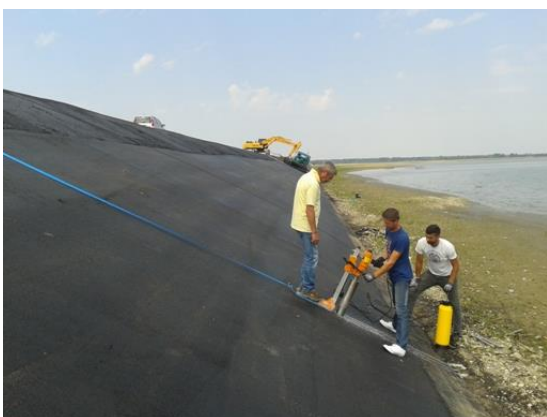
Slika 58. Uzorkovanje uzoraka iz ugrađenog asfaltnog sloja bušenjem
