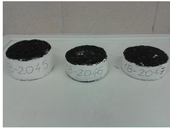
Slika 61. Izvađeni uzorci iz ugrađenog asfaltnog sloja (bočno brtvljeni za ispitivanje vodoneprop.)
