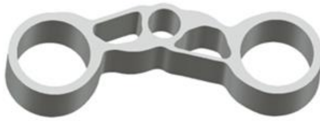
Slika 4.2.5-6 Primjer ishoda za opciju "2- osno rezanje"[23].
