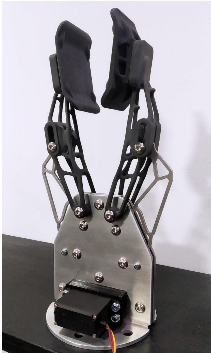
Slika 10-1 Sklopljeni prototip robotske hvataljke.
