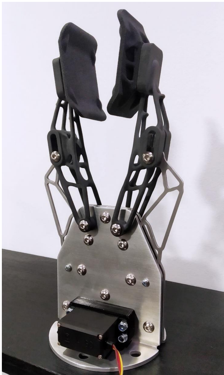
Slika 10-1 Sklopljeni prototip robotske hvataljke.
