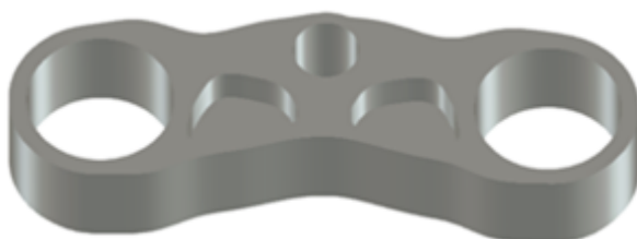
Slika 4.2.5-3 Primjer ishoda za opciju "2.5-osno glodanje"[23].
