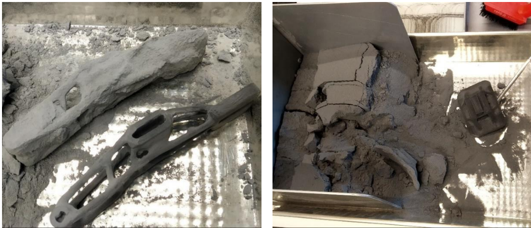
Slika 9-2 Prikaz čišćenja elemenata nakon SLS postupka ispisa.
