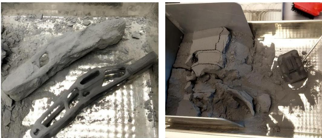
*Slika 9-2 Prikaz čišćenja elemenata nakon SLS postupka ispisa.*
