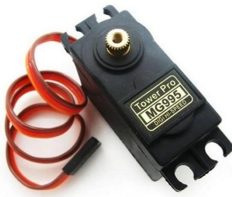
Slika 9.1-1 Servo-motor TowerPro MG995
