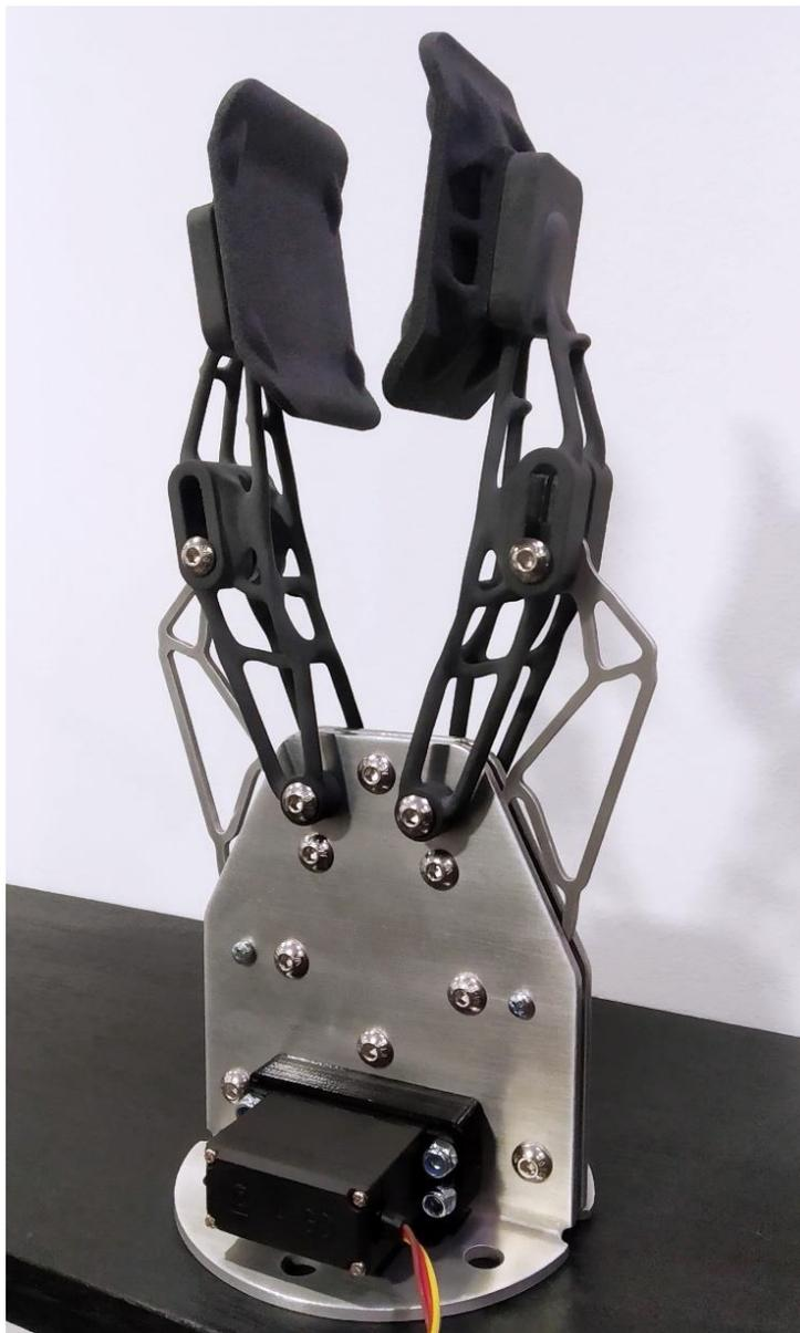
*Slika 10-1 Sklopljeni prototip robotske hvataljke.*
