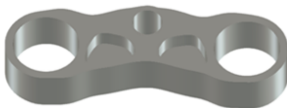
Slika 4.2.5-3 Primjer ishoda za opciju "2.5-osno glodanje"[23].
