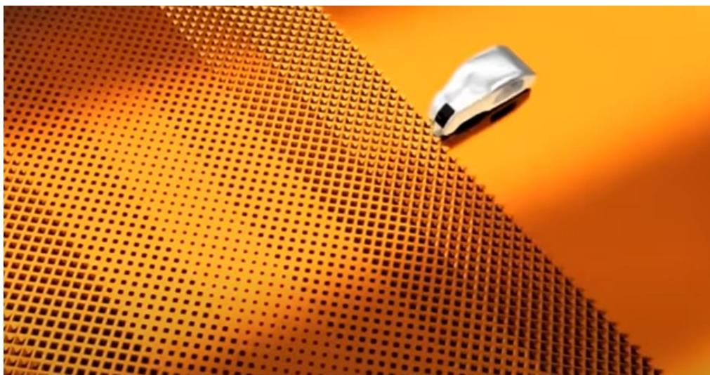
*Slika 20. Elektromehaničko graviranje
