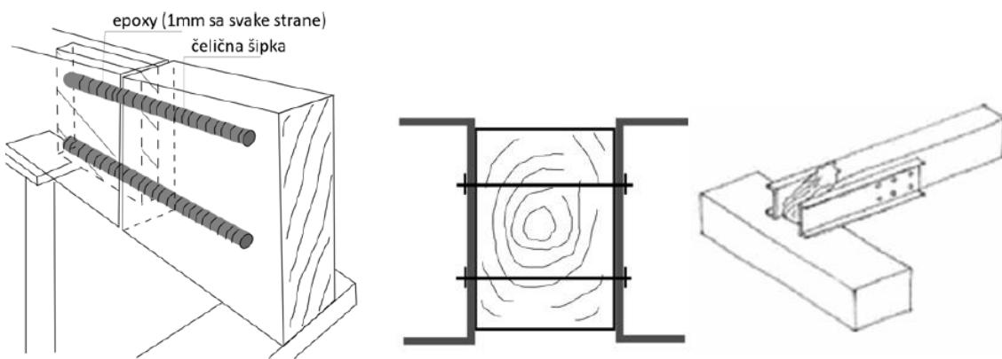
Slika 4.20: Sanacija drvenih greda čeličnim šipkama i epoksidnim ljepilom (lijevo) i sanacija i pojačanje drvenih greda dodavanjem čeličnih elemenata (sredina, desno)
