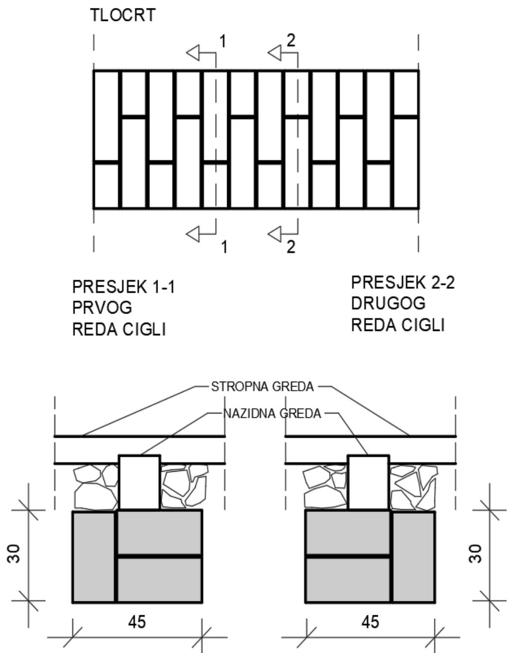
Slika 5.61: Tlocrt i presjek nadvoja
