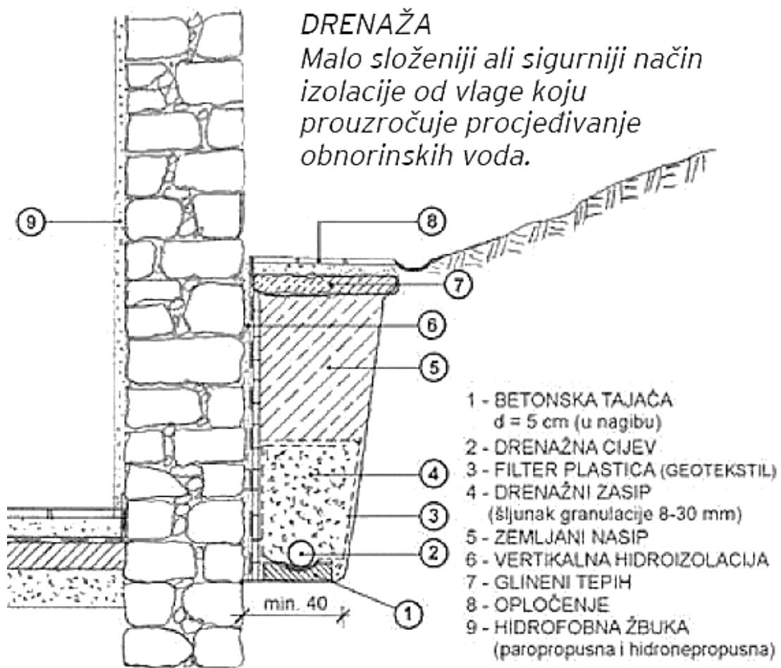
Slika 4.25: Detalj drenaže uz vanjski zid od kamena [7]
