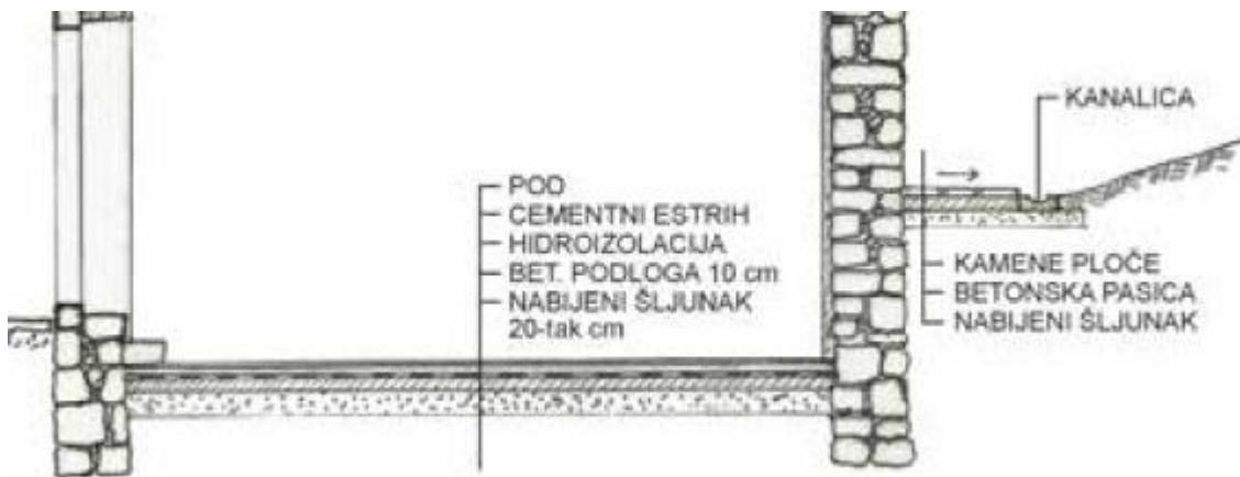
Slika 4.24: Presjek kamene kuće, prijedlog sanacije vlage [7]
