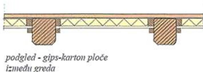
Slika 4.18: Presjek stropne konstrukcije s gips-kartonskim pločama [10]
