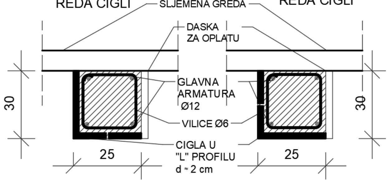
Slika 5.67: Tlocrt i presjek nadvoja
