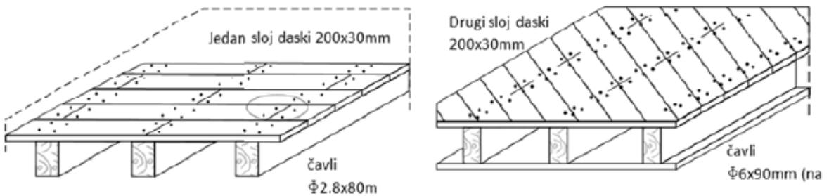
Slika 4.19: Prikaz polaganja drvenih dasaka na stropnoj konstrukciji [9]
