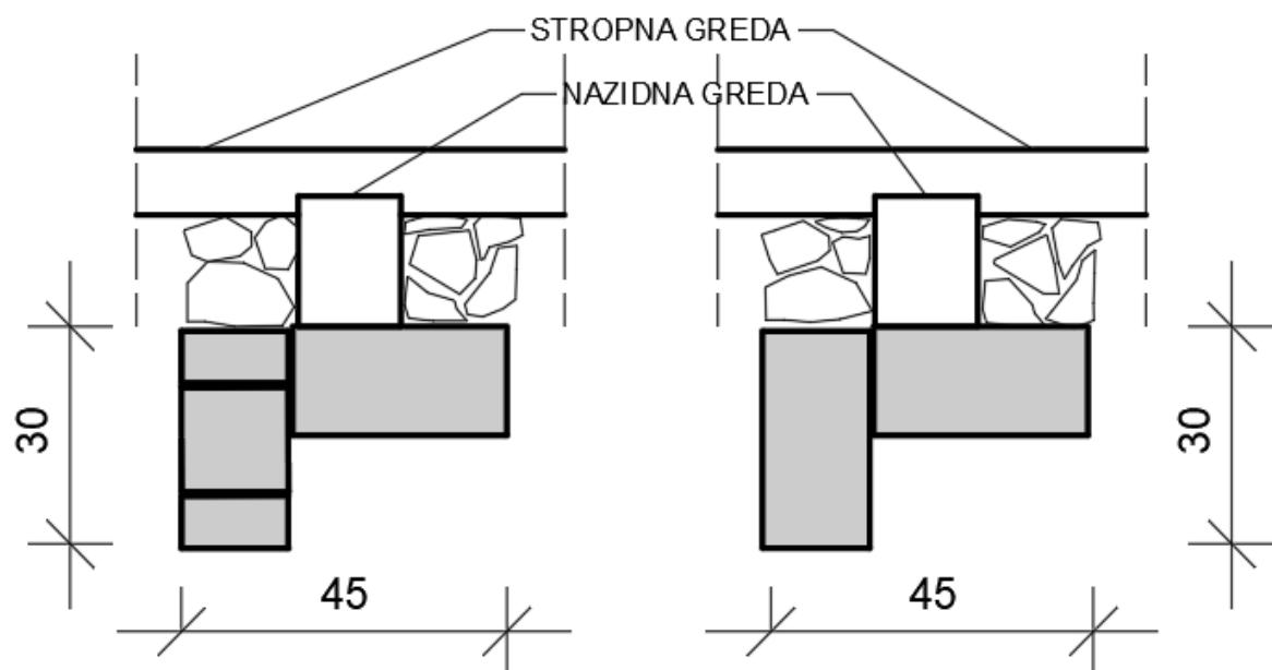
Slika 5.64: Tlocrt i presjek nadvoja
