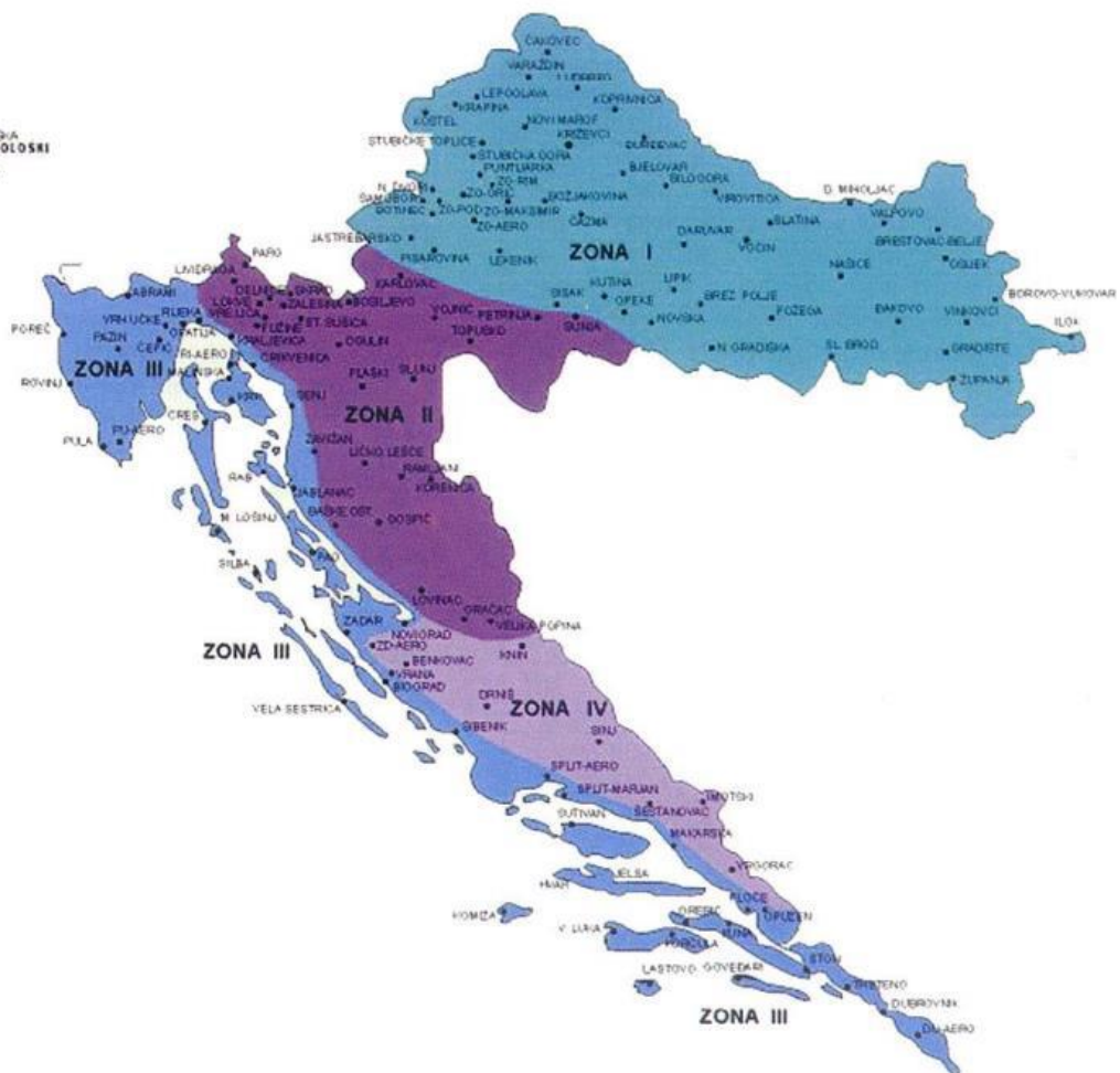
Slika 7.2: Klimatske zone karakterističnog opterećenja snijegom za razdoblje 1961.-1990 [17]
