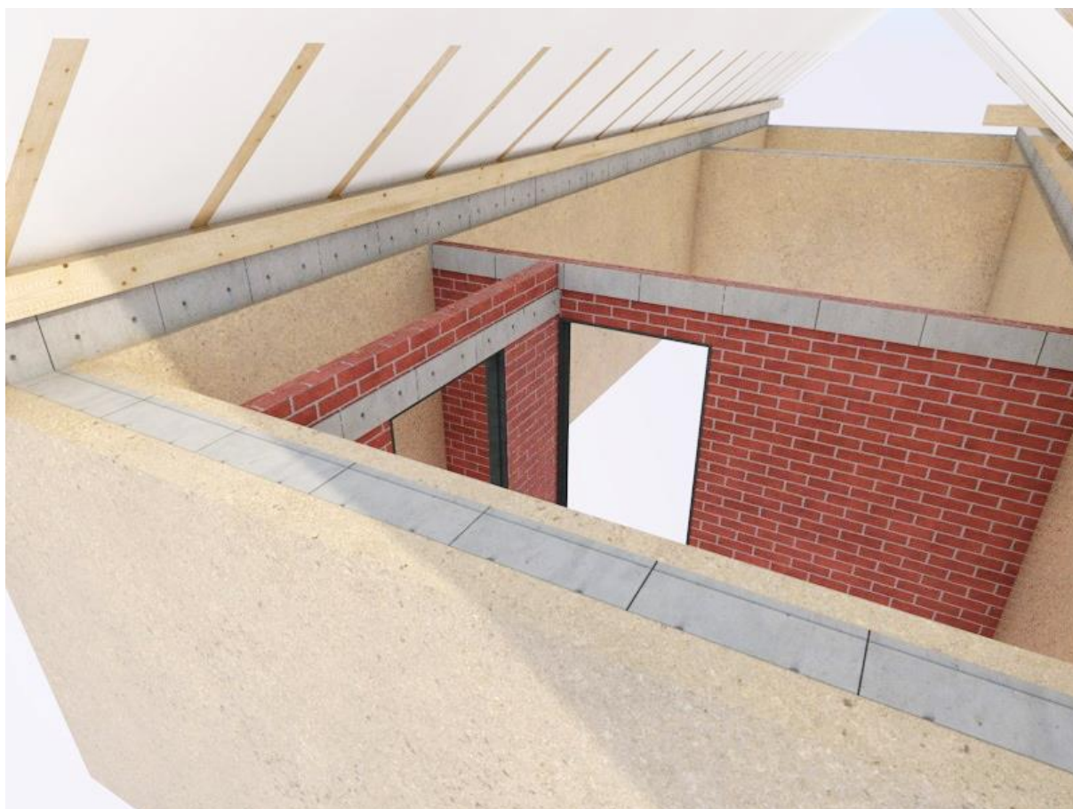
Slika 5.29: Aksonometrijski prikazi serklaža u objektu
