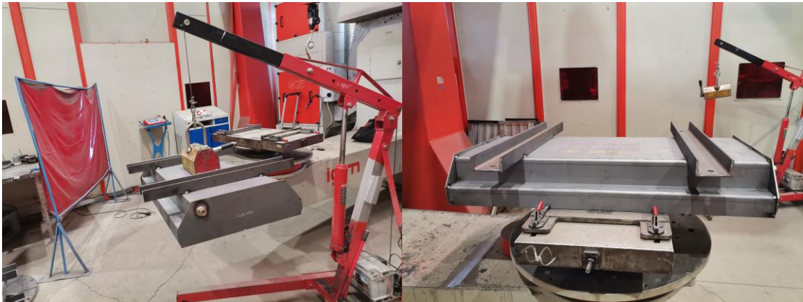
Slika 5.17. Stavljanje dna na pozicioner [osobne slike]
