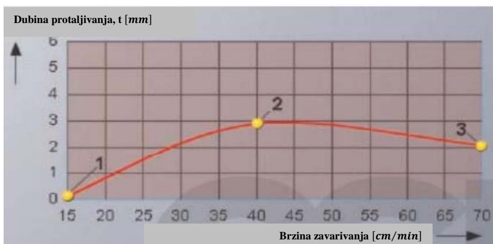
Slika 3.5. Ovisnost dubine protaljivanja o brzini zavarivanja [7]
