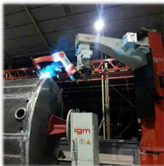
Slika 4.1. Robotizirani MIG/MAG postupak zavarivanja [9]
