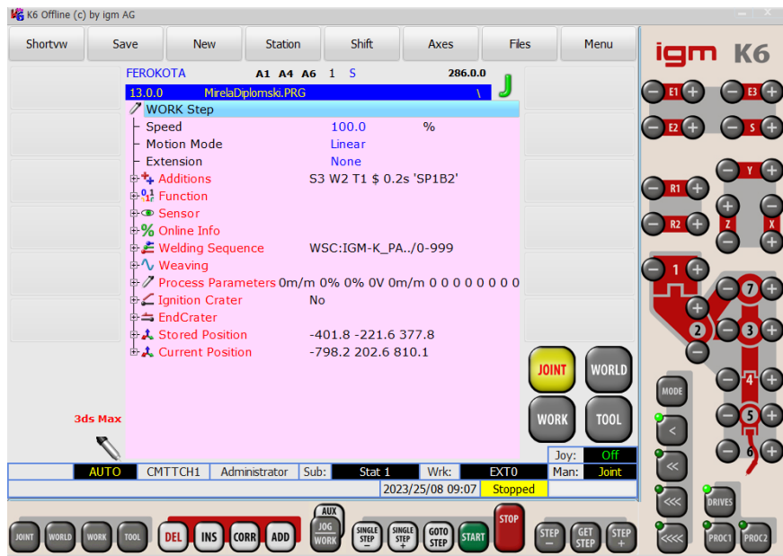
Slika 5.9. WORK korak programiranja [osobne slike]
