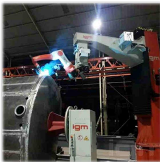
Slika 4.1. Robotizirani MIG/MAG postupak zavarivanja [9]
