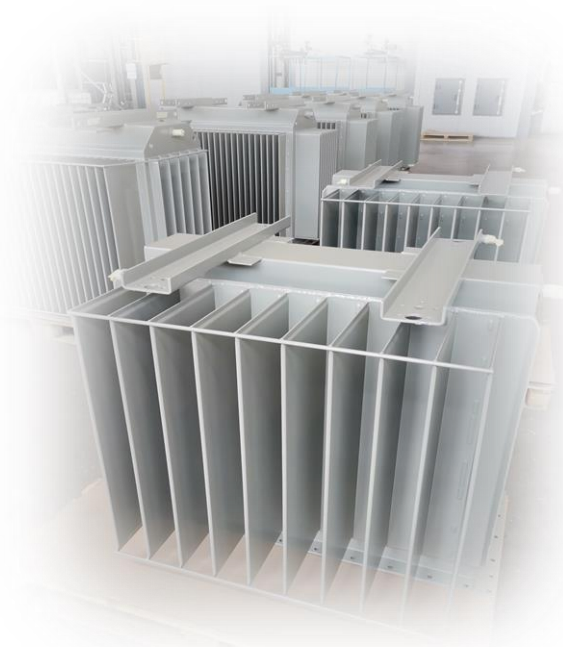
Slika 5.2. Distribucijski transformator [osobne slike]
