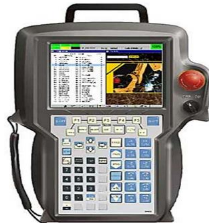
Slika 4.4. On – line programiranje [16]
