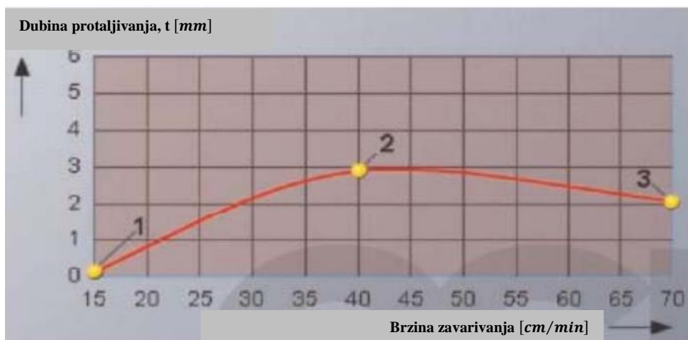
Slika 3.5. Ovisnost dubine protaljivanja o brzini zavarivanja [7]
