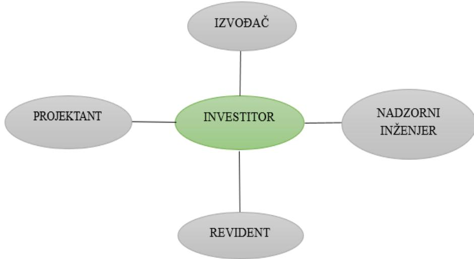
**Slika 1. Shema sudionika u gradnji (izvor: vlastita slika)**
