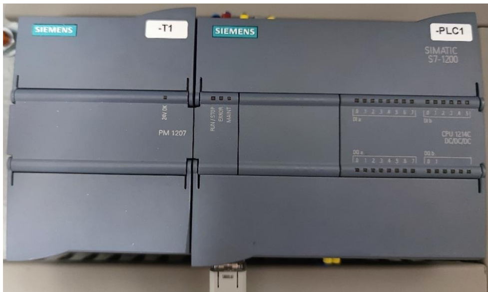
Slika 28. Fotografija korištenog PLC-a i napajanja
