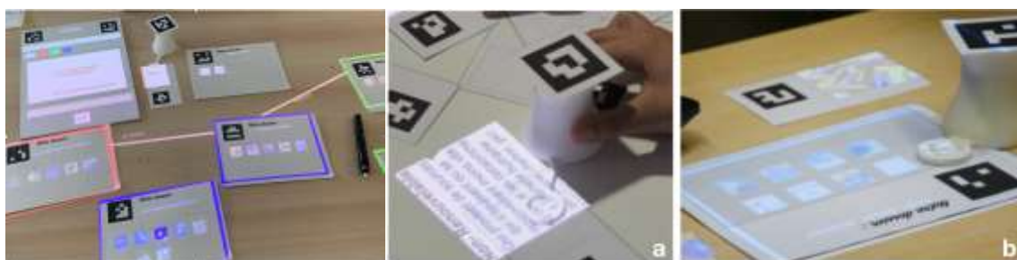
Slika 4.4 AR sustav u uporabi – projekiranej sučelja na augmetirani papir
