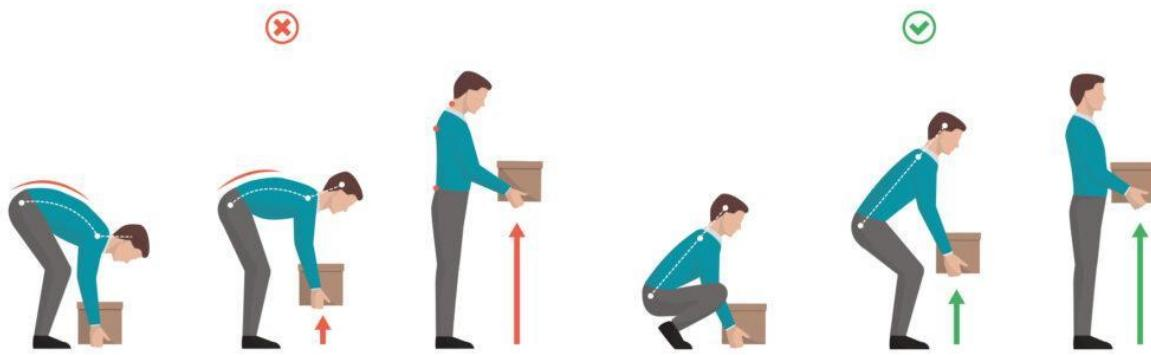
*Slika 5.5.1. Prikaz nepravilnog i pravilnog podizanja tereta*
