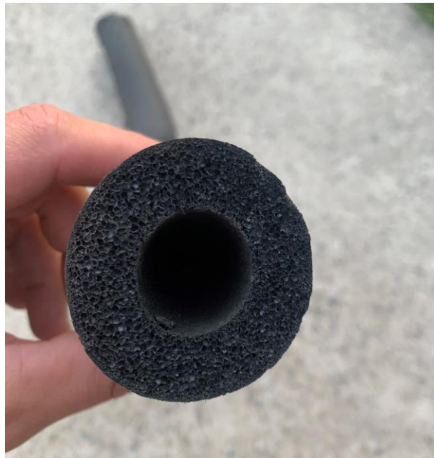
Slika 6.3. Izolacija bakrene cijevi, (Ivan Podravec-31.3.2023.)
