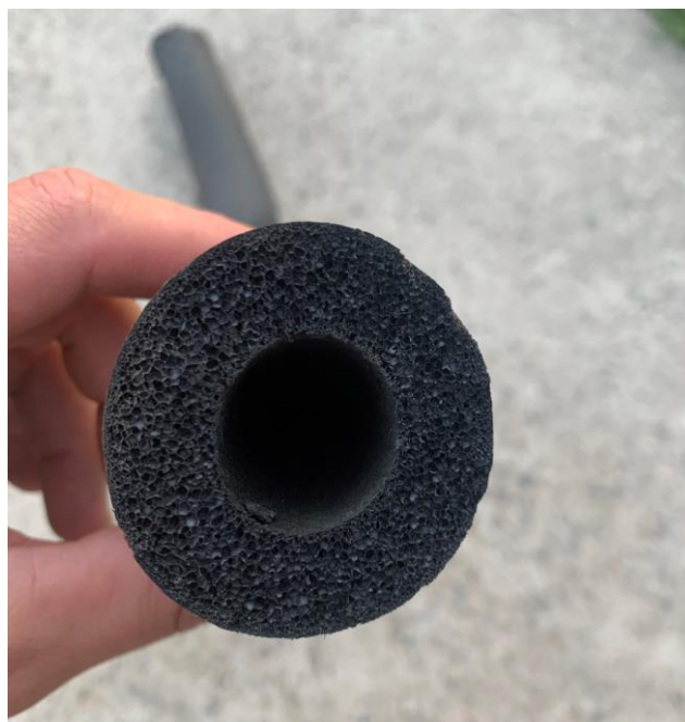
Slika 6.3. Izolacija bakrene cijevi, (Ivan Podravec-31.3.2023.)
