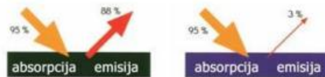
Slika 4.1. Klasična i selektivna površina (preuzeto s interneta)
