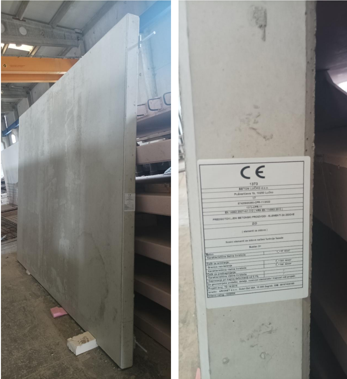
Slika 35:Odlaganje gotovih pločastih elemenata u pogonu Beton Lučko d.o.o. (izvor: osobna arhiva)
