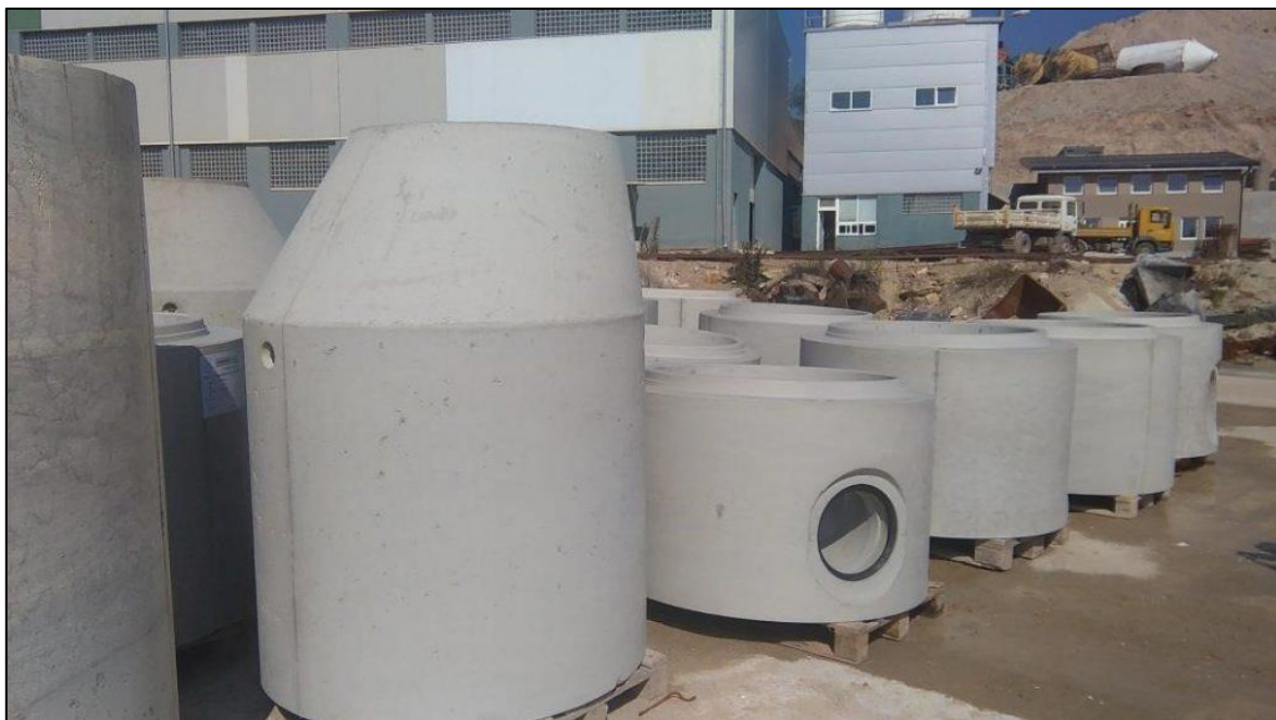
Slika 2: Betonska kanalizacijska okna (izvor: http://termo-beton.com/perfect-saht/ , pregledano 20.10.2022.)
