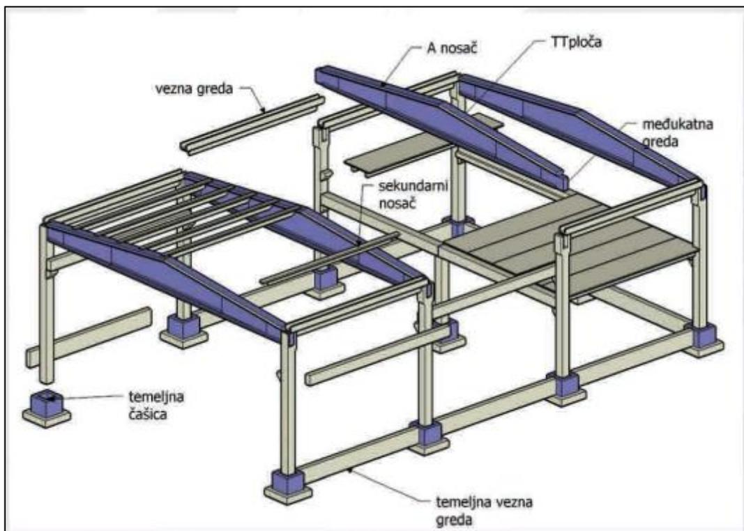
**Slika 6: Montažna betonska hala – montažni elementi**
