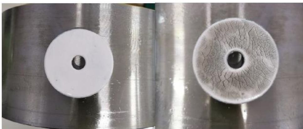
Slika 3.14.: Magnetsko ispitivanje na etalonu korištenjem nefluorescentnih čestica [18]
