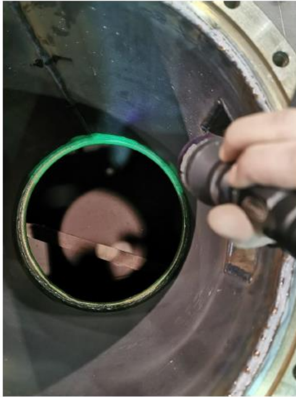
Slika 3.11.: Ispitivanje fluorescentnim penetrantom [18]
