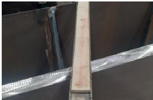
Slika 5.1.: Keramička podloga za zavarivanje [34]
