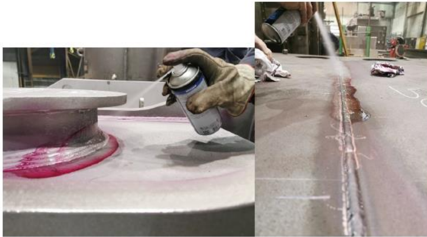
Slika 3.8.: Odstranjivanje penetranta s površine [18]
