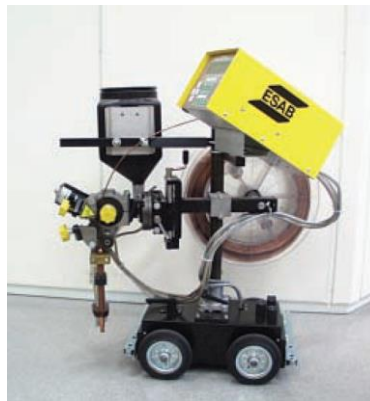
Slika 5.2.: Automat za EPP zavarivanje [33]
