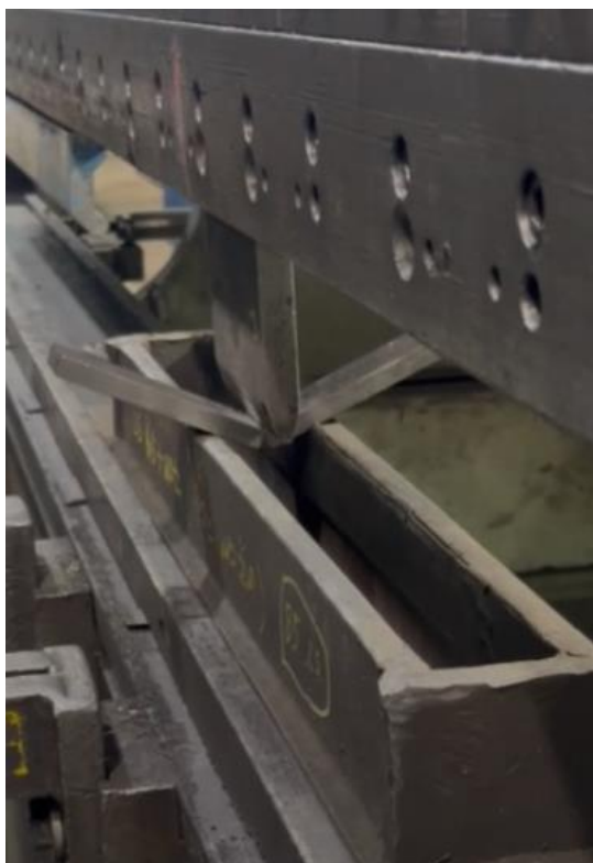
Slika 5.12.: Savijanje uzorka na stroju za savijanje [34]
