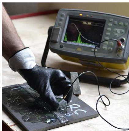
Slika 3.4. Ultrazvučno ispitivanje zavarenog spoja [15]
