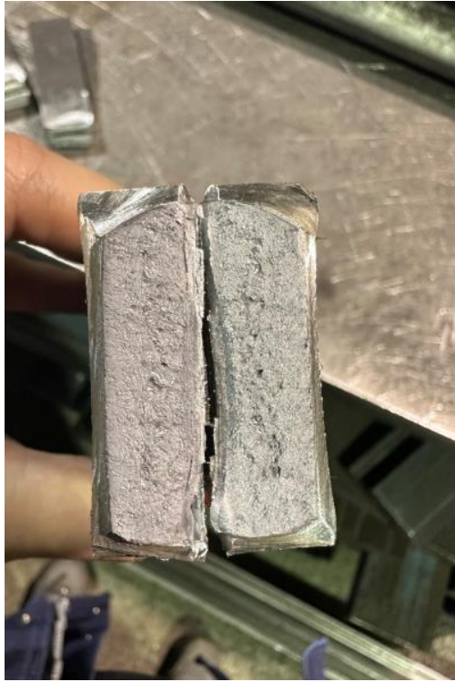
Slika 5.13.: Presjek zavarenog uzorka nakon prijeloma [34]
