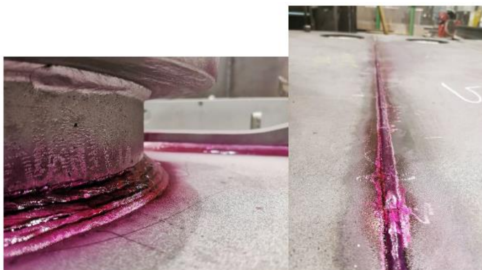
Slika 3.7.: Naneseni crveni penetrant [18]
