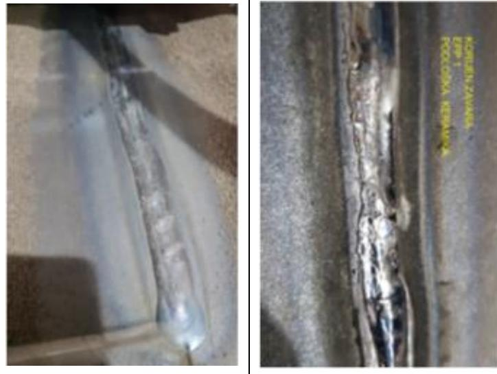
Kod uzorka EPP1 jakost električne struje je preniska i nije dobiveni provareni korijen.
