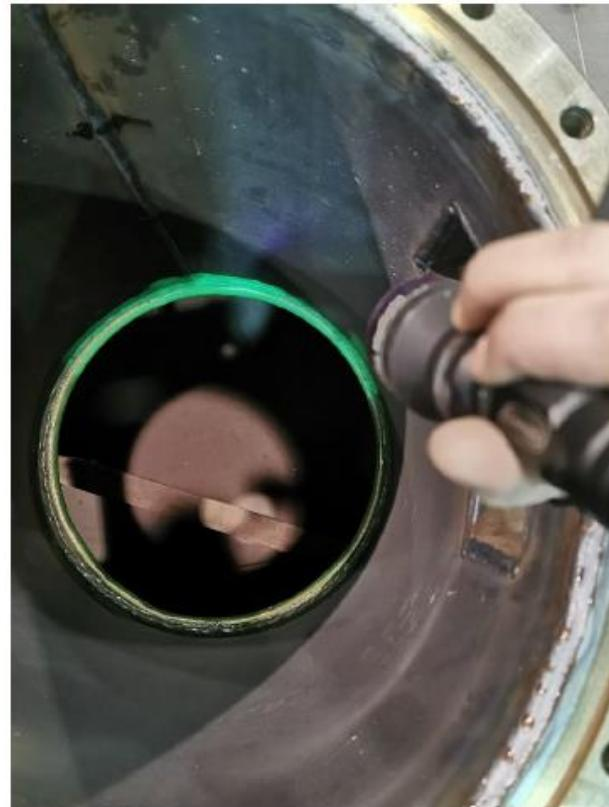
Slika 3.11.: Ispitivanje fluorescentnim penetrantom [18]
