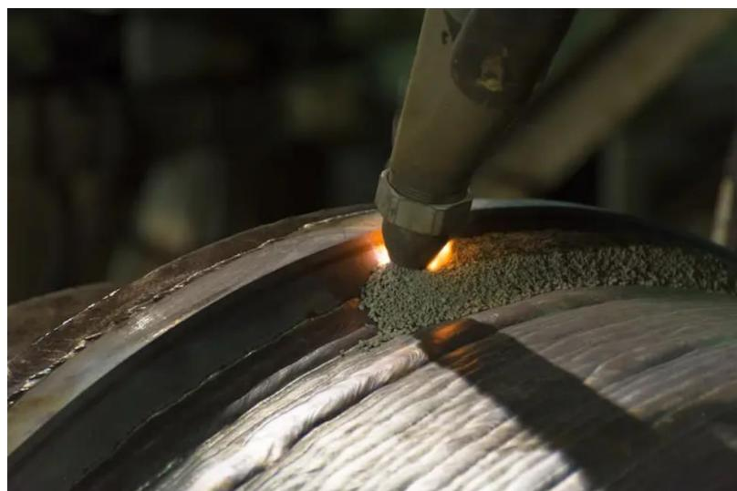
Slika 2.3.: Elektrolučno zavarivanje pod zaštitom praška [6]
