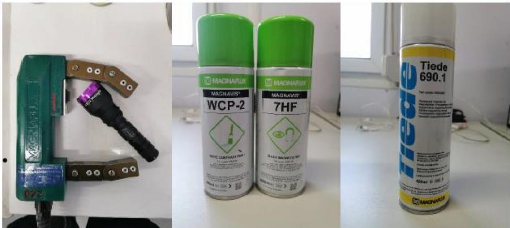
Slika 3.12.: Oprema za magnetsko ispitivanje [18]
