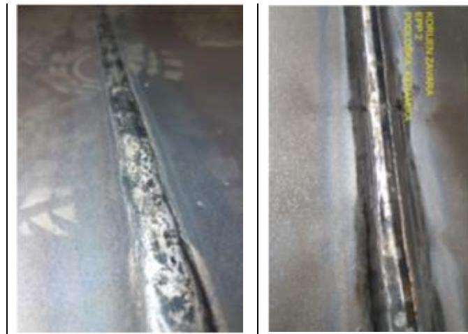
Kod uzorka EPP2 korijen je potpuno provareni uz minimalne deformacije ploče. Od parametara je promijenjena samo jakost električne struje za 50 A što je dovoljno da se korijen potpuno provari u odnosu na prethodni uzorak jer jačina električne struje utječe na dubinu penetracije zavara.
