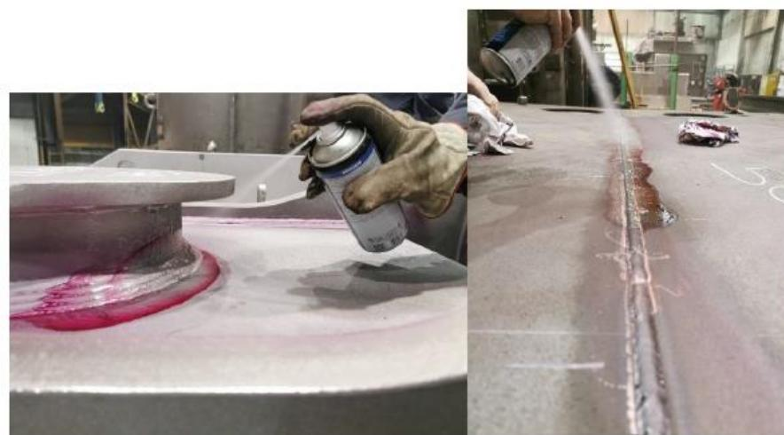
Slika 3.8.: Odstranjivanje penetranta s površine [18]
