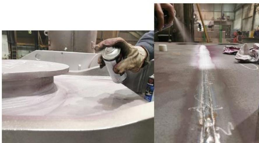
Slika 3.9.: Nanošenje razvijača [18]
