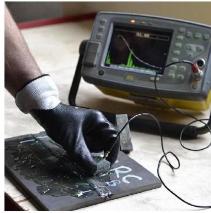
*Slika 3.4. Ultrazvučno ispitivanje zavarenog spoja [15]*
