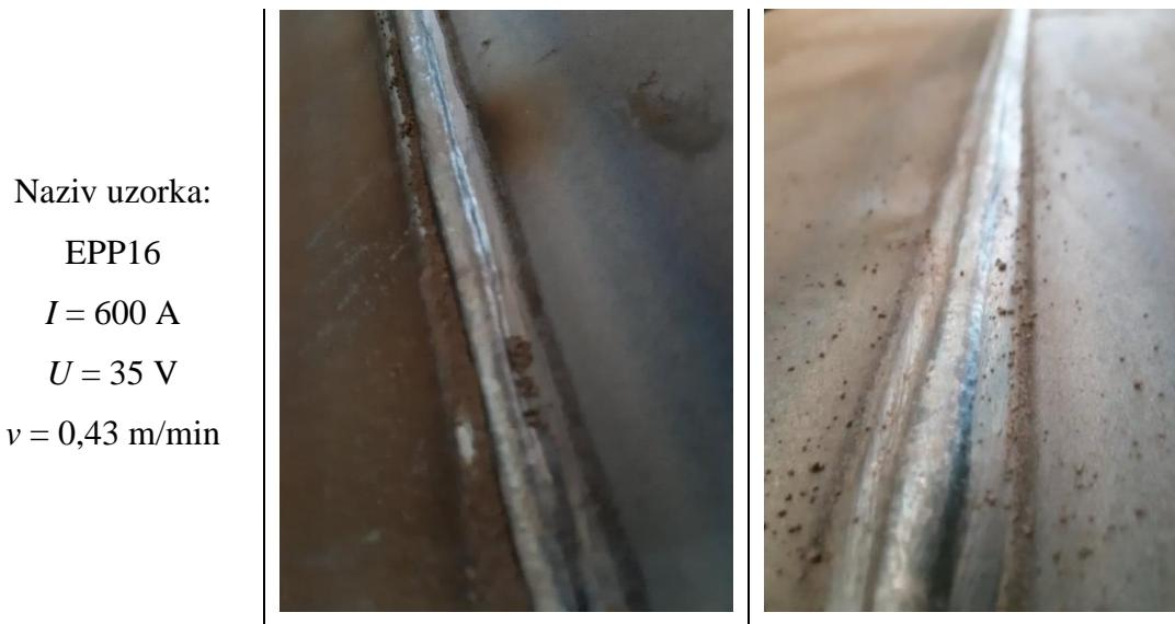
Kod uzorka EPP16 lice zavara i korijen zavara su previše ispupčeni. Ovo je još jedan primjer kod kojega se vidi da već kod malih pomaka u parametrima dolazi do velike promjene kvalitete zavara.
