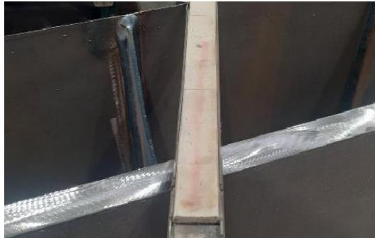
Slika 5.1.: Keramička podloga za zavarivanje [34]
