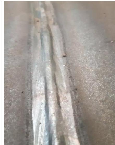
Kod uzorka EPP17 je samo jakost električne struje smanjena u odnosu na onu korištenu kod uzorka EPP15 i korijen zavara je manje ispupčeni jer se smanjenjem jakosti električne struje smanjuje penetracija.
