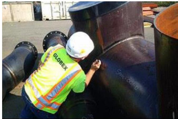
Slika 3.1.: Provodenje vizualnog ispitivanja zavarenog spoja [12]
