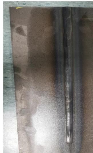
Kod uzorka EPP41 jakost električne struje i napon su približno isti kao i kod svakog prikazanog uzorka, ali je brzina znatno smanjena i time je dobivena najbolja širina lica zavara i potpuno provareni korijen. Kod ovog uzorka zavarivanje je provedeno obostrano. Obostrano zavarivanje se primjenjuje zbog bolje kvalitete izvedenog zavarenog spoja. Smanjuje se
