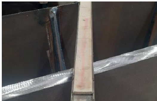
Slika 5.1.: Keramička podloga za zavarivanje [34]
