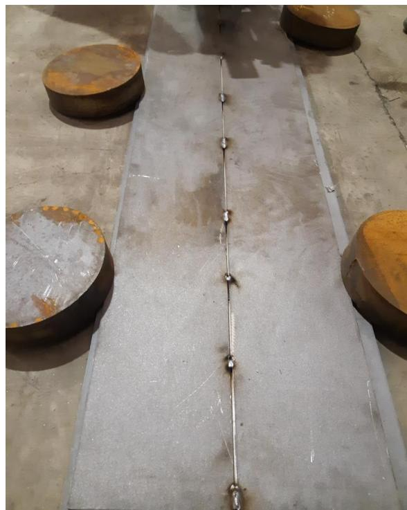
*Slika 5.4.: Pripajanje ploča prije zavarivanja [34]*
