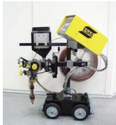
Slika 5.2.: Automat za EPP zavarivanje [33]
