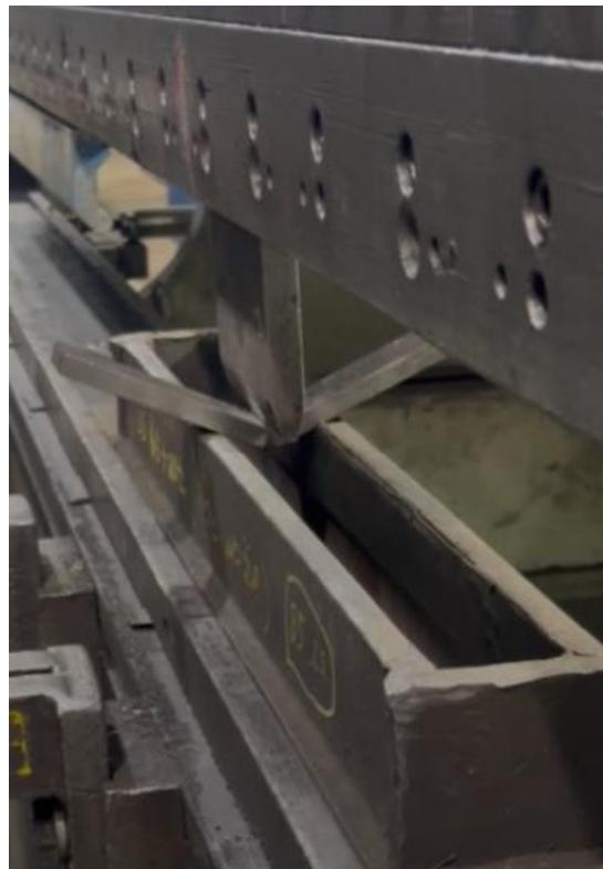
Slika 5.12.: Savijanje uzorka na stroju za savijanje [34]
