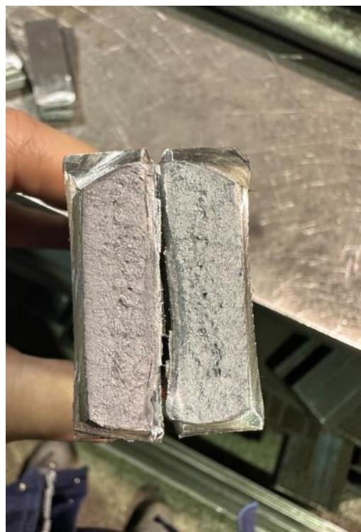
*Slika 5.13.: Presjek zavarenog uzorka nakon prijeloma [34]*
