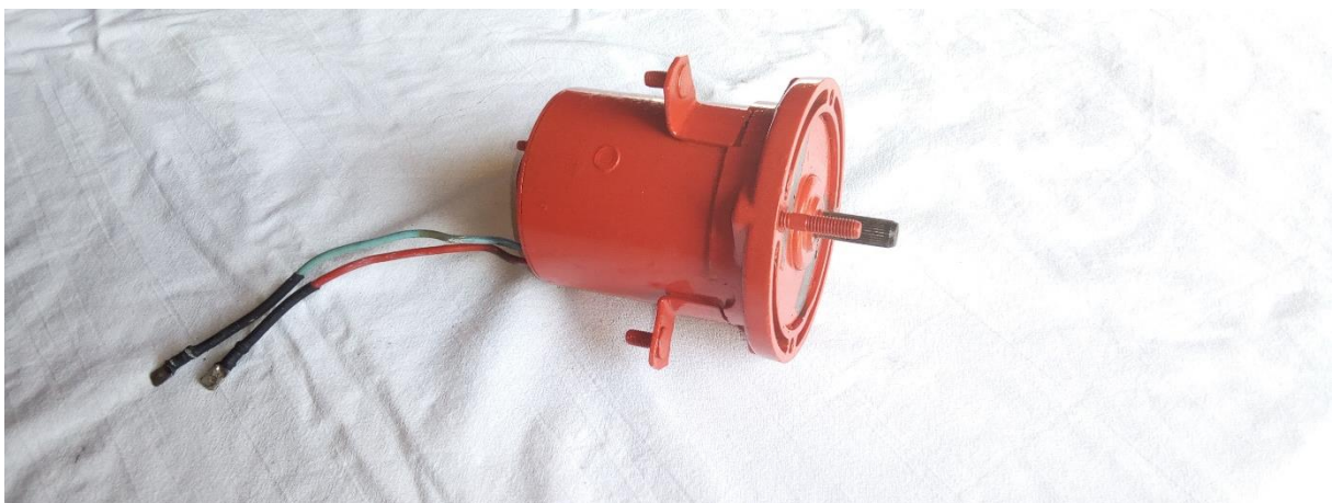
Slika 4.14. Elektromotor s ugrađenom prirubicom
