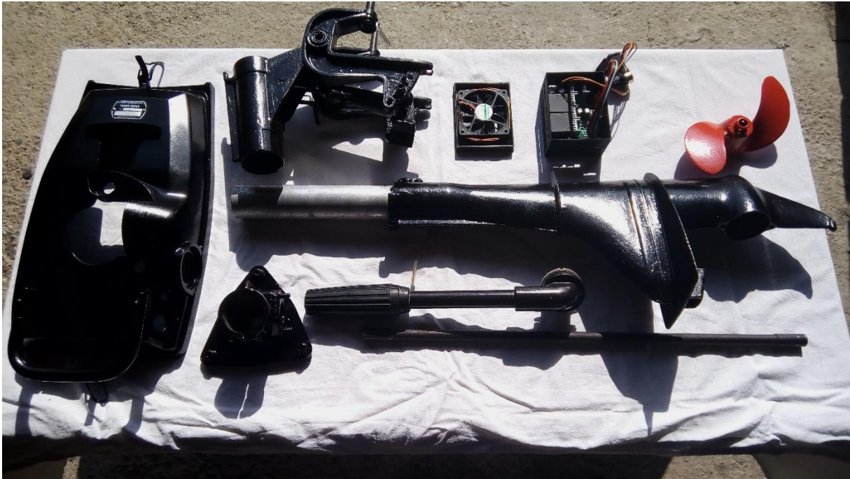
Slika 4.11. Prikaz obnovljenih dijelova motora i novih dijelova elektronike
