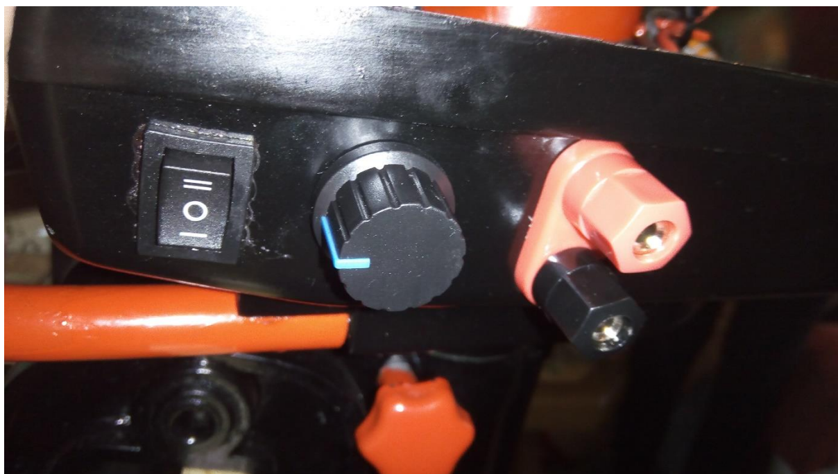
Slika 4.18. Prekidač za biranje smjera kretanja, potenciometar i priključak vanjskog akumulatora
